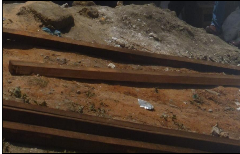
Figura 3.36. Madera estructural para durmites de 4"x2"x12' y 4"x2"x10'- madera tornillo curado con petróleo y asfalto líquido
