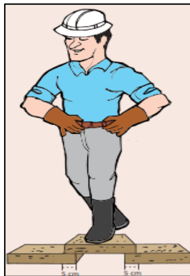
Figura 1.20. Prueba de resistencia del adobe
