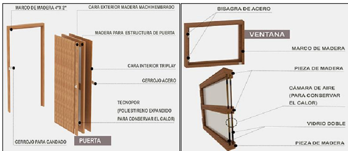
Figura 3.41. Componentes de puerta y ventana
