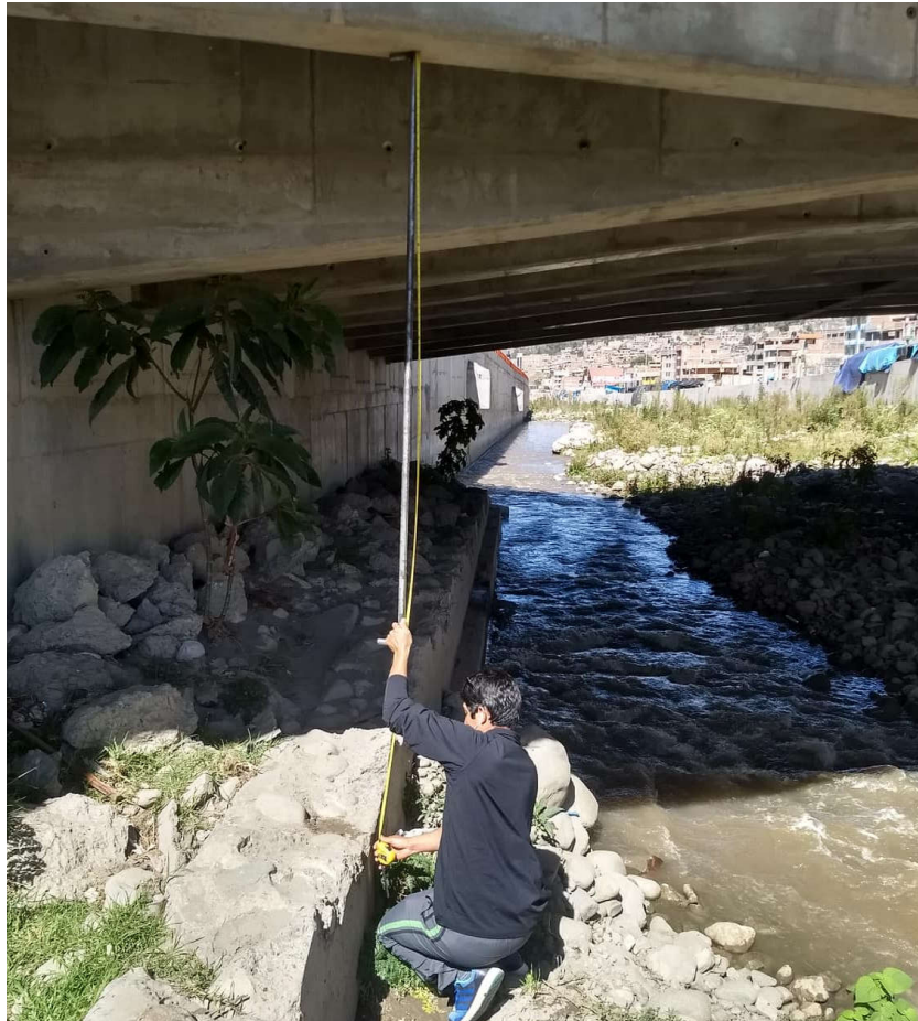
Medición de la altura hasta el fondo del río
