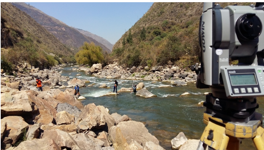
Figura 3.28: Batimetría con estación total y prismas
