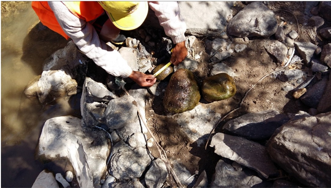
Figura B.8: Medición del diámetro de rocas del interior del río Urubamba
