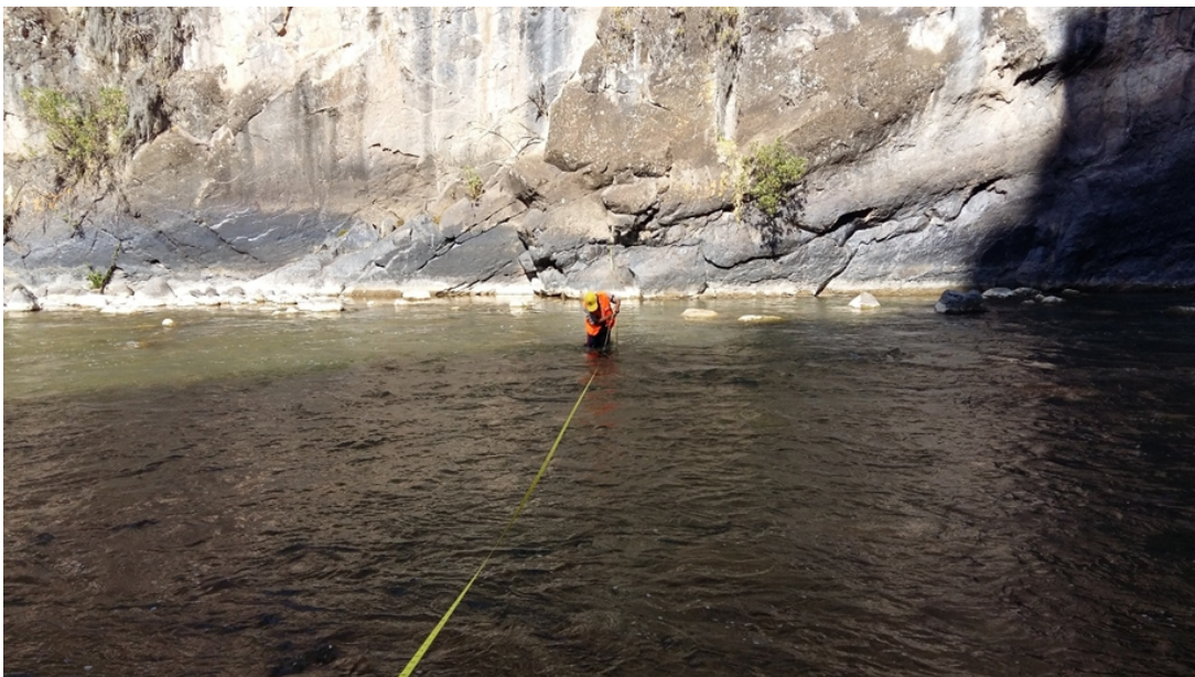
Figura B.3: Medición de seccionamiento del río Urubamba
