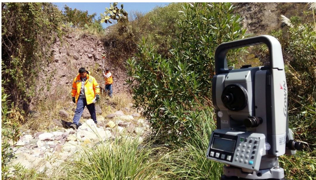
Figura B.4: Realizando el levantamiento topográfico en sus afluentes del río Urubamba
