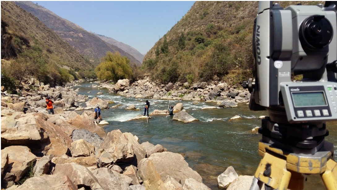
Figura B.6: Batimetría del río Urubamba con estación total y prismas
