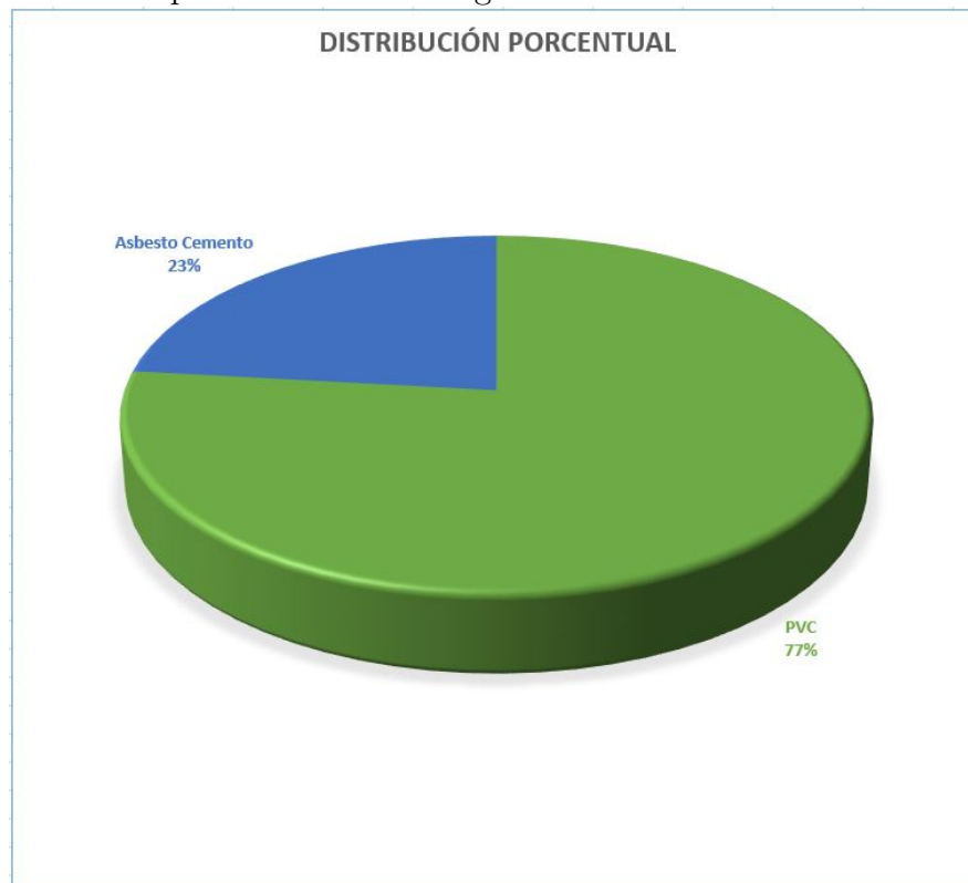
Figura 3.6: Distribución porcentual de las longitudes de tubería de acuerdo al tipo de material
