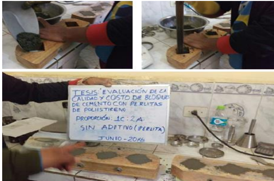
Figura 3.26: Procedimiento de elaboración en el moldeo de los especímenes cúbicos.
