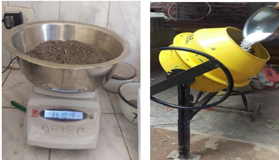
Figura 3.38: Pesado y mezcladora para la preparación del bloque de cemento con perlita de poliestireno.
