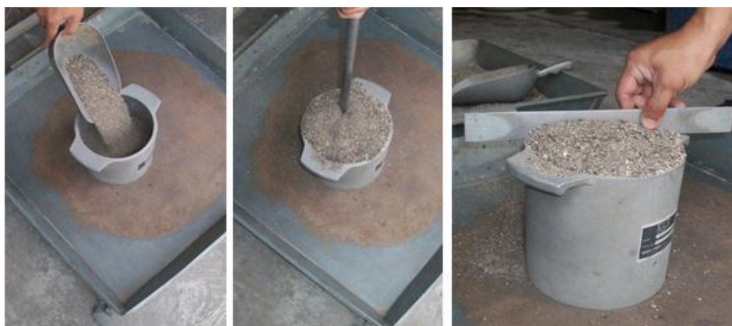
Figura 3.19: Proceso de llenado, varillado por capas y enrasado.
