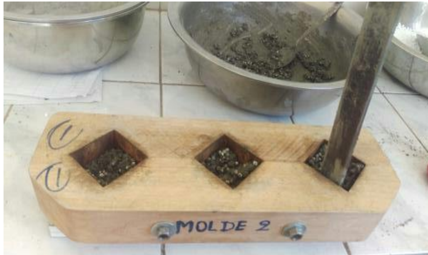
Figura 3.31: Preparación de especímenes del mortero cemento con perlita de poliestireno.
