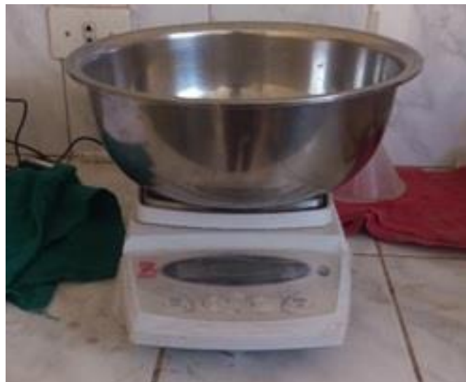
Figura 3.11: Pesado de las cantidades retenidas del tamiz.
