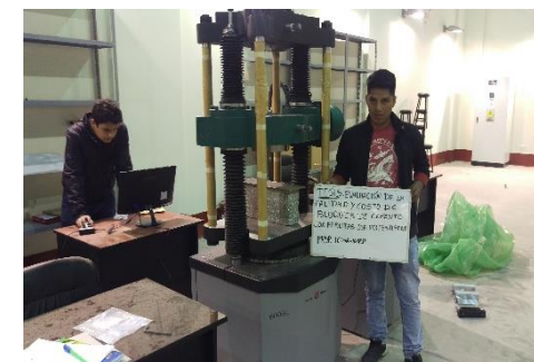
Ensayo de resistencia a la compresión
