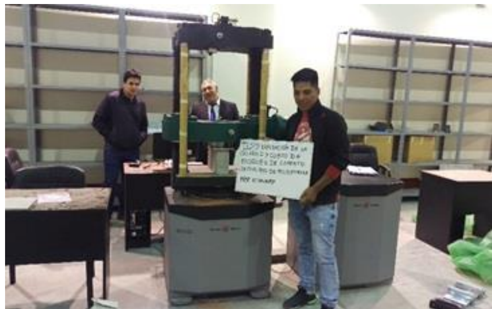
Figura 3.46. Ensayo a la compresión de unidad de bloques de cemento con perlitas poliestireno 19x9x39cm (Lab. UNSCH-Setiembre, 2018).
