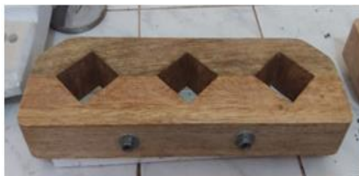
Figura 3.22: Molde para elaborar especímenes de mortero cemento de 5x5x5cm para los ensayos.
