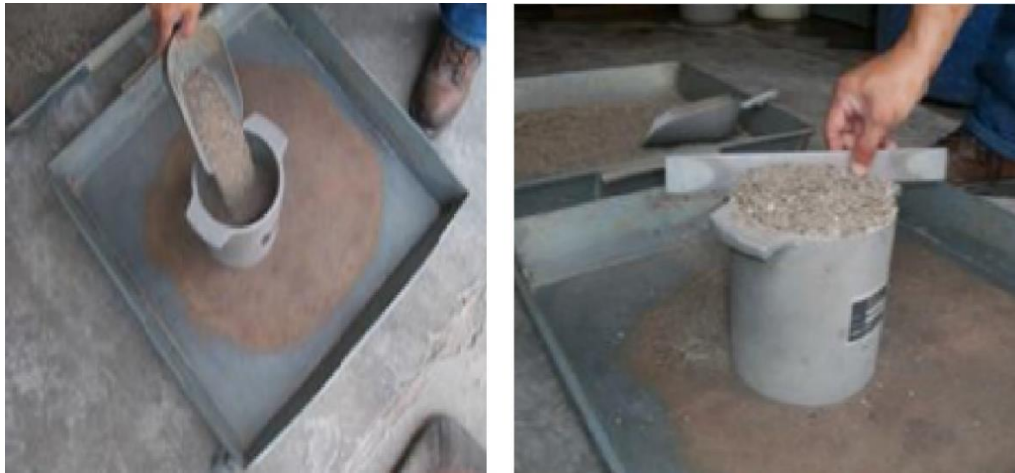
Figura 3.18: Proceso de llenado y enrasado
