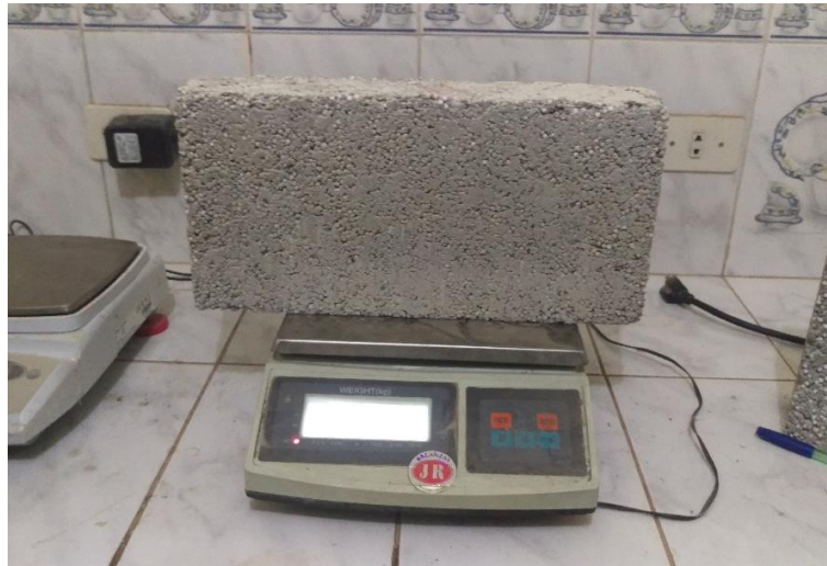
Figura 3.47. Pesado del bloque de cemento con perlitas poliestireno seco de 28 días de edad.
