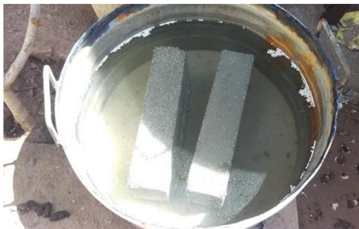
Figura 3.48. Bloque de cemento con perlitas poliestireno sumergido en agua durante 24 horas.
