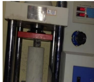
Ensayo de resistencia a la compresión
