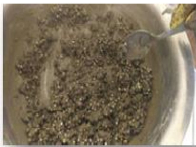
Figura 3.30: Amasado del mortero cemento con perlitas de poliestireno.
