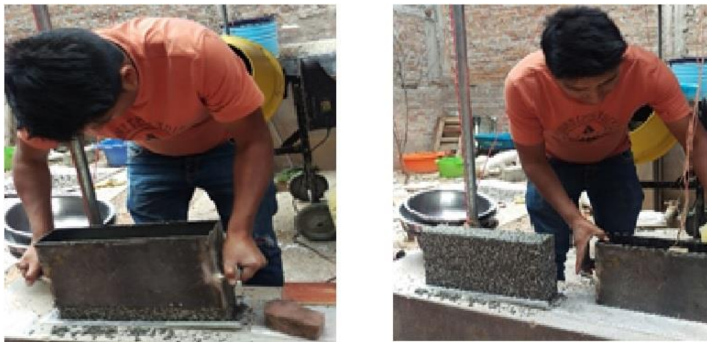
Figura 3.41: Desmolde y producto final del bloque.
