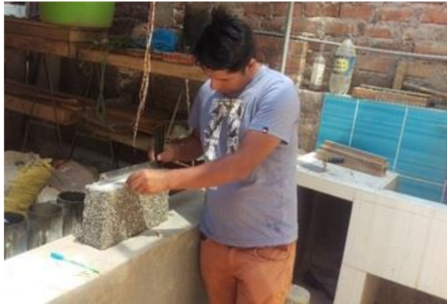
Figura 3.50. Verificando el Alabeo del bloque.
