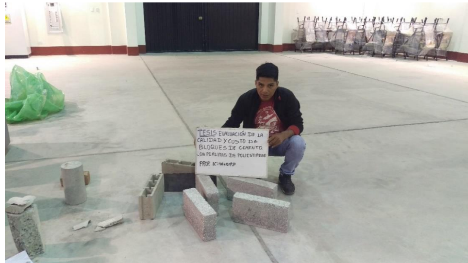
Figura 3.45. Muestras de bloque de cemento con perlitas poliestireno antes del ensayo a la compresión de unidad.
