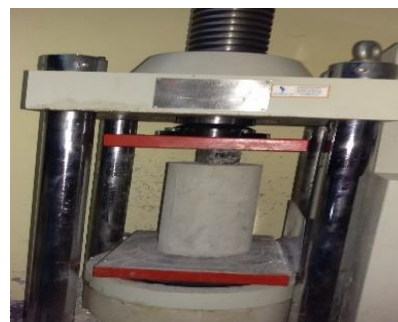
Ensayo de resistencia a la compresión
