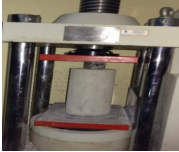
Ensayo de resistencia a la compresión
