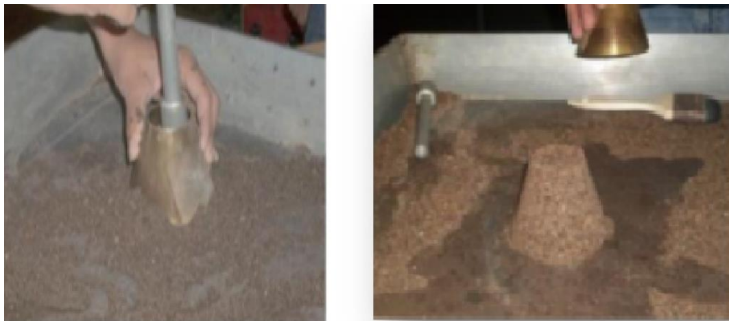
Figura 3.13: Procedimiento del cono truncado para la humedad superficial (según N.T.P)
