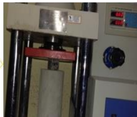
Figura 4.1: Muestras de cubetas preparados y ensayo de rotura a la compresión.
