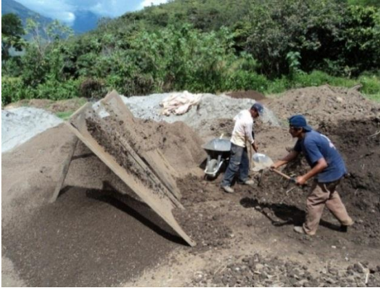
Foto 22. Tamizado de materiales para sustrato.
