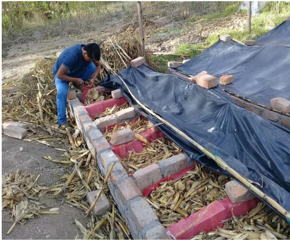
Foto 2.17. Lectura de la temperatura del compost en cada unidad experimental
