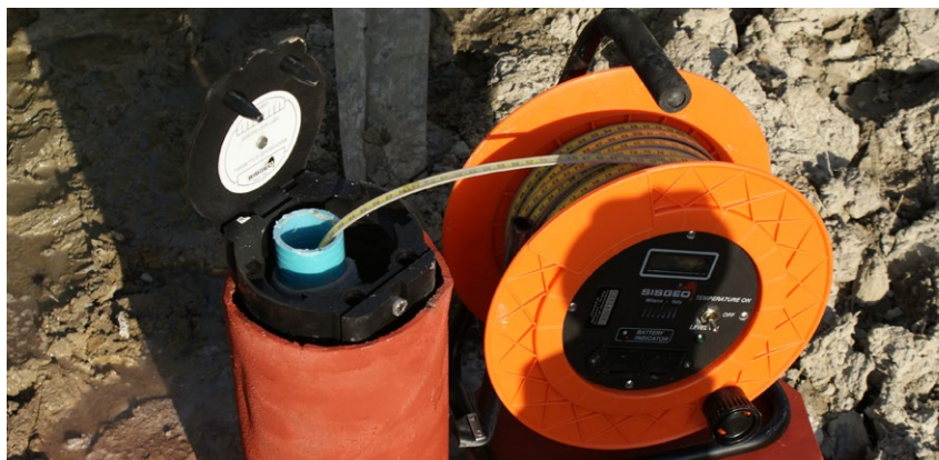
Figura 22 Piezómetro de Casagrande fuentes: Imagen tomada de Geokon, 2012
