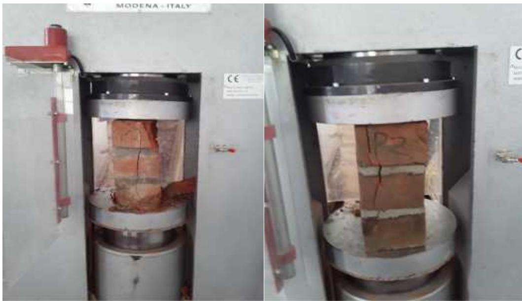
Figura 4.3: Muestra la forma de falla de las pilas de albañilería P2. Fuente propia.
