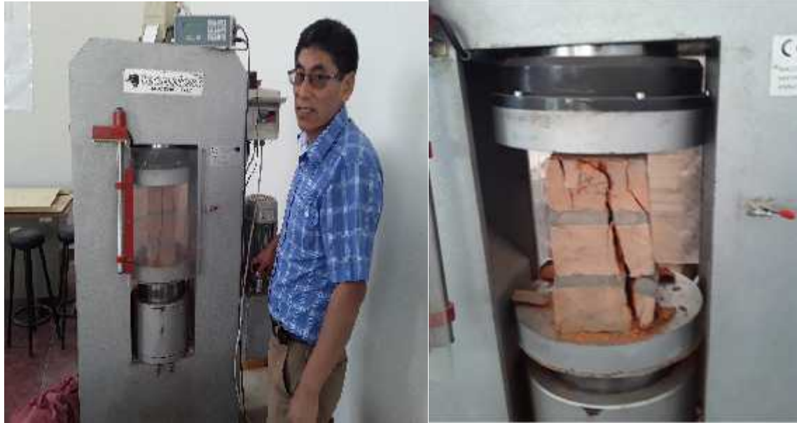
Figura 4.1: Muestra la forma de falla de las pilas de albañilería K2. Fuente propia.
