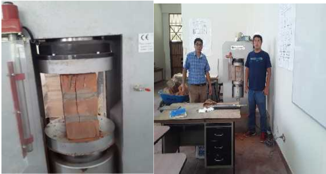
Figura 4.4: Muestra la forma de falla de las pilas de albañilería P1. Fuente propia.
