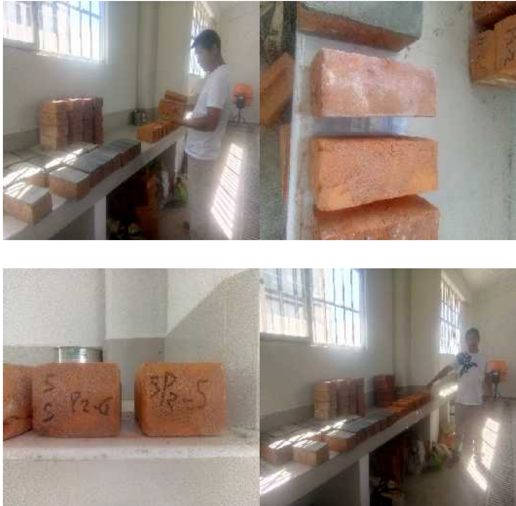
Figura 3.13: Muestra el Proceso de Realizar el Ensayo de Eflorescencia de las Unidades de Albañilería. Fuente propia
