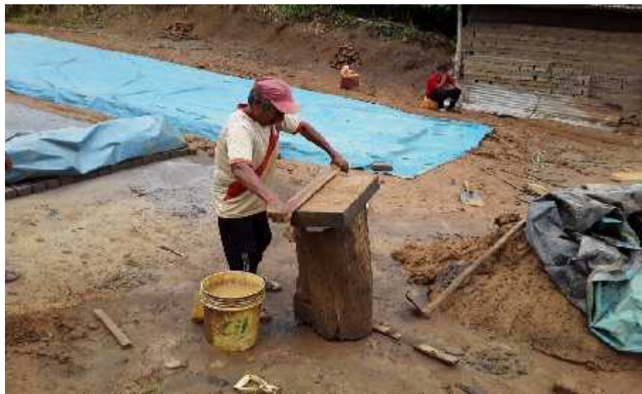
Figura 2.4: Moldeado artesanal de la Materia Prima y Enrasado. Fuente propia.
