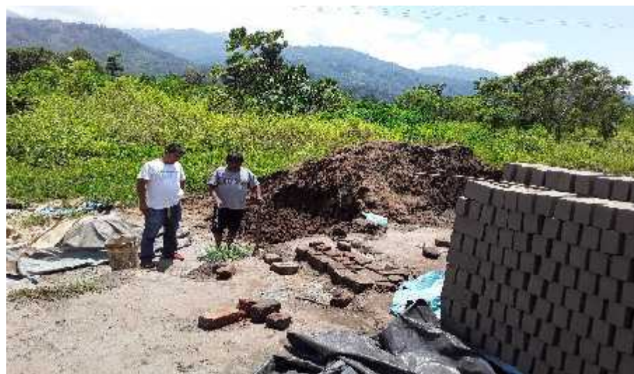
Figura 3.10: Obsérvese la materia prima que tiene una coloración negruzca o tierra orgánica a simple vista en P1. Fuente: propia.
