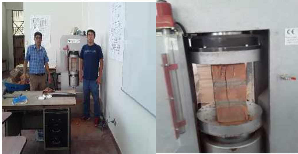
Figura 3.16: Muestra el Proceso de Ensayo de Resistencia a la Compresión de las Pilas de Albañilería. Fuente propia.
