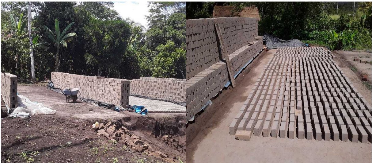
Figura 3.17: Ruma de ladrillos y el secado al aire libre de ladrillos puesto de canto. Fuente:
