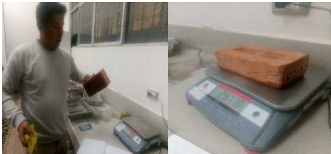
Figura 3.12: Muestra el Proceso de Realizar la Succión de las Unidades de Albañilería. Fuente propia.
