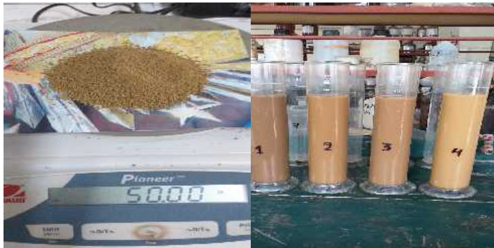
Figura 3.8: Secado y el Proceso de Sedimentación de las 4 Materias Primas. fuente: proporcionada por el laboratorista.
