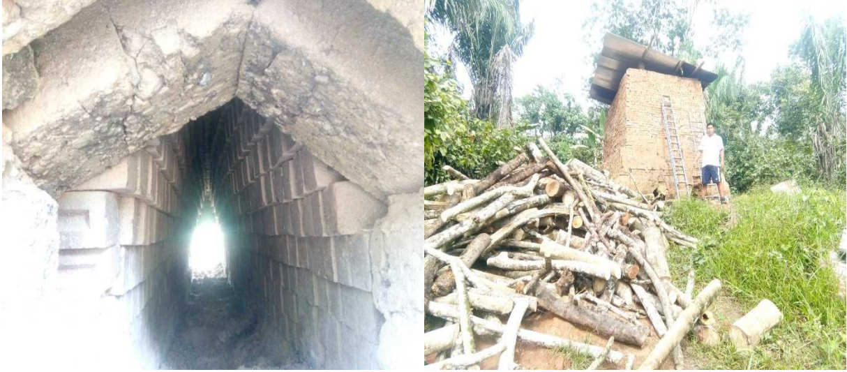
Figura 3.20: Cajonado del horno y leña para la cocción de ladrillos. Fuente: propia
