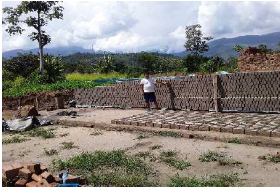
Figura 2.5: Secado de los Ladrillos artesanales en el Tendal. Fuente propia
