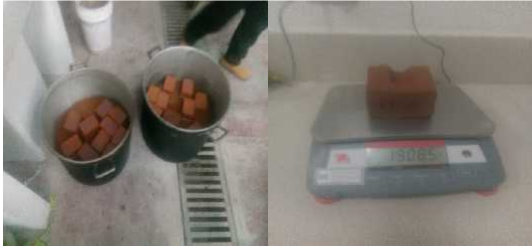
Figura 3.11: Proceso de Realizar la Absorción Máxima de las Unidades de Albañilería. Fuente propia.
