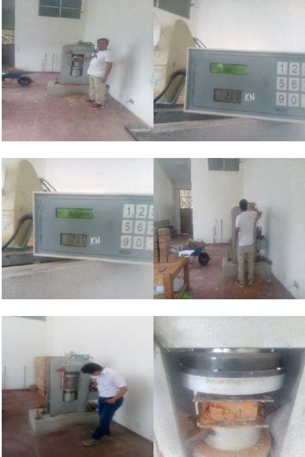
Figura 3.15: Muestra el Proceso de Ensayo de Resistencia a la Compresión de las Unidades de Albañilería. Fuente propia
