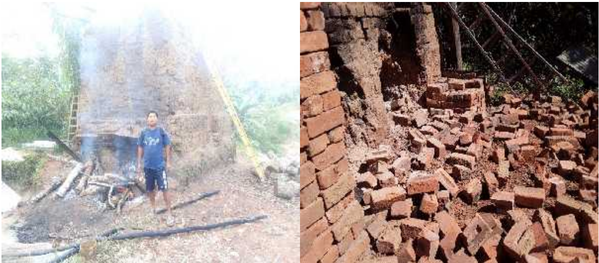
Figura 3.21: Quemado de ladrillos y ladrillos muy quemados (rocochado). Fuente: propia
