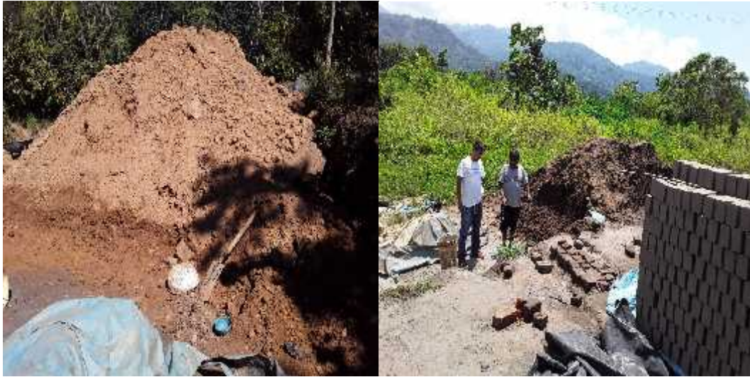
Figura 3.12: Obsérvese la materia prima acumulada y al costado la materia prima amasada y fermentando. Fuente: propia.
