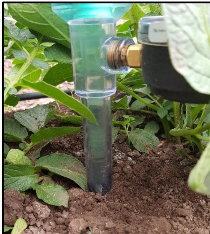
**Fotografía 10:** Lectura del manómetro del tensiómetro (10 cm y 20 cm)
