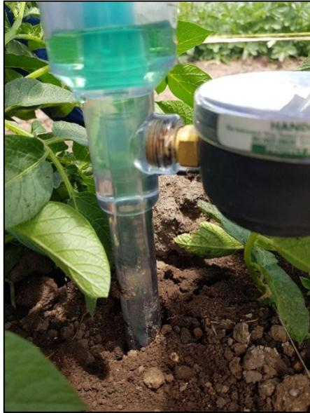
**Figura 2.14.** Tensiómetro en campo
