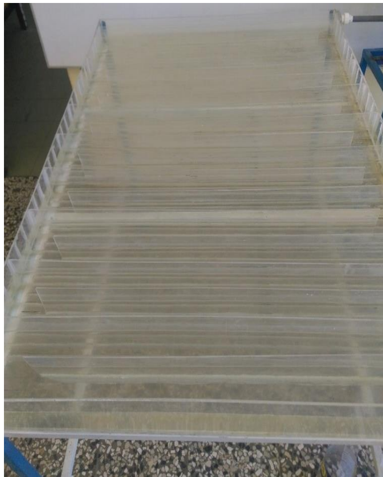
Figura IV-13. Vista del floculador hidráulico de flujo horizontal
