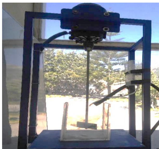
Figura IV-12. Vista frontal del tanque reactor de mezcla rápida
