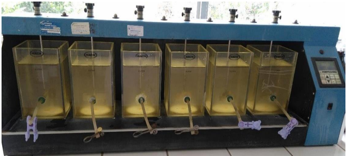
Vista de la prueba de jarra durante la floculación
