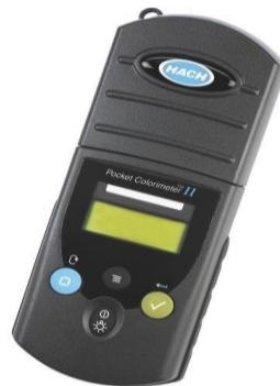
Figura III-2. Medidor de cloro residual (HACH)
