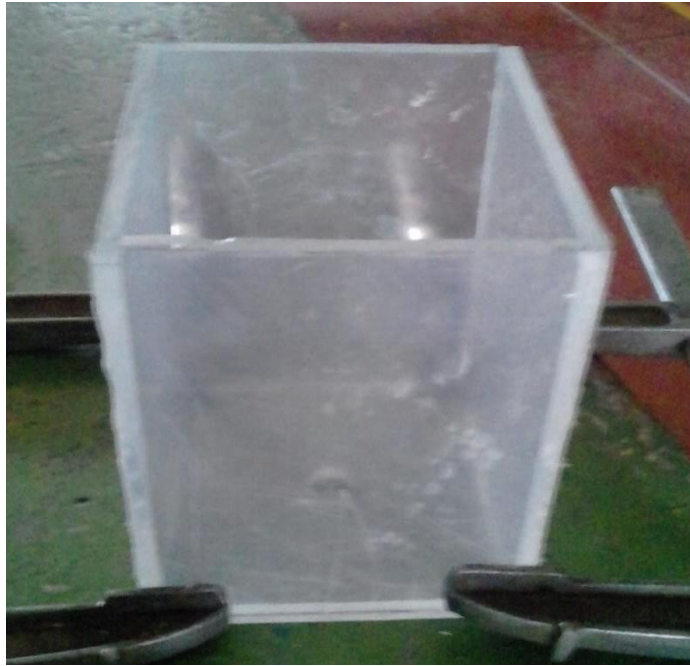
Vista del tanque de mezcla rápida durante la construcción
