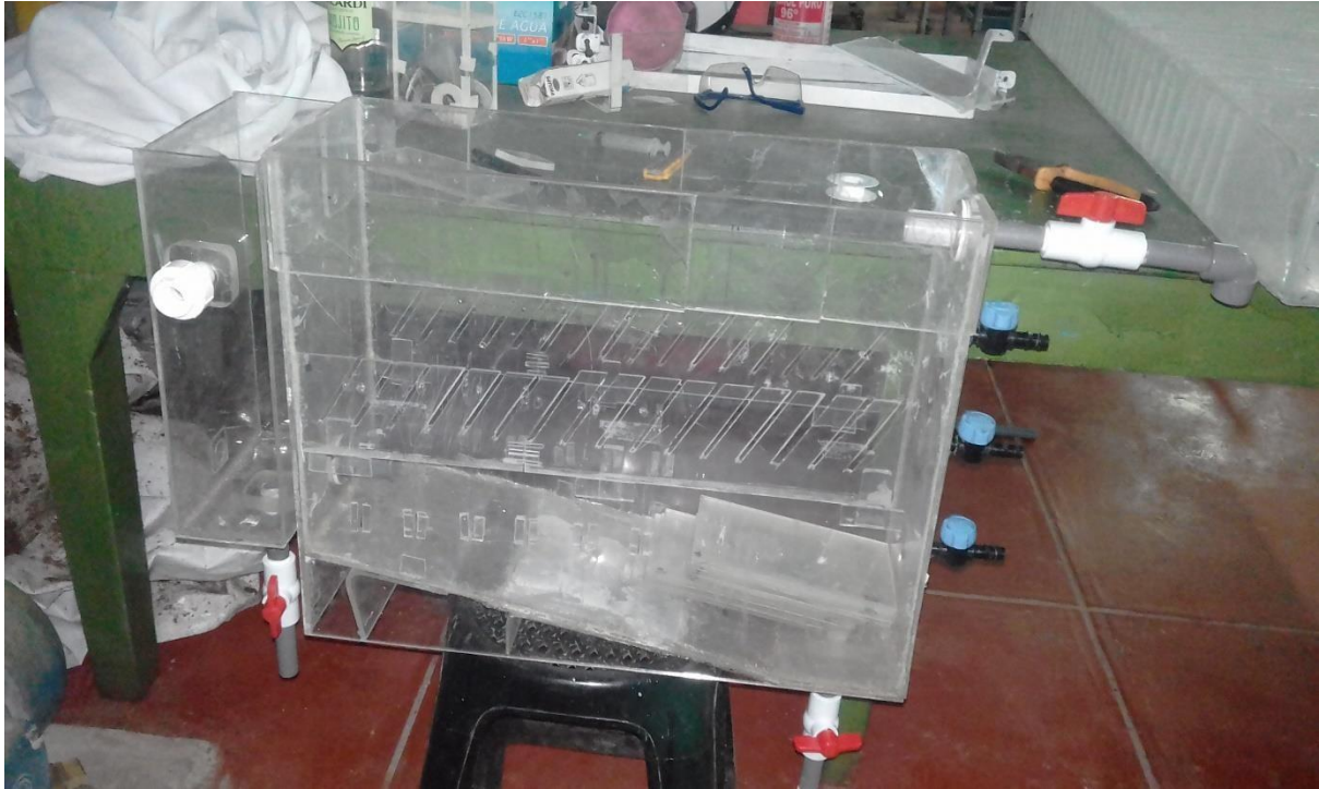
Vista de la construcción del tanque sedimentador
