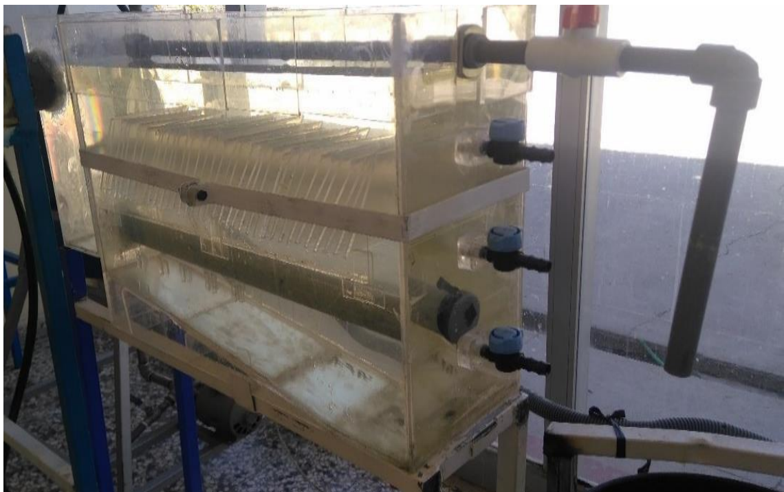
Figura IV-14. Vista frontal del sedimentador de alta tasa
