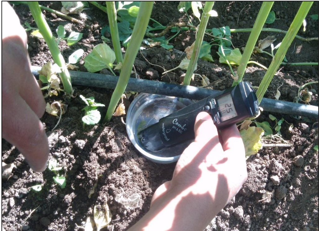
Fotografía 43. Evaluación del PH, C.E y T° del fertirriego
