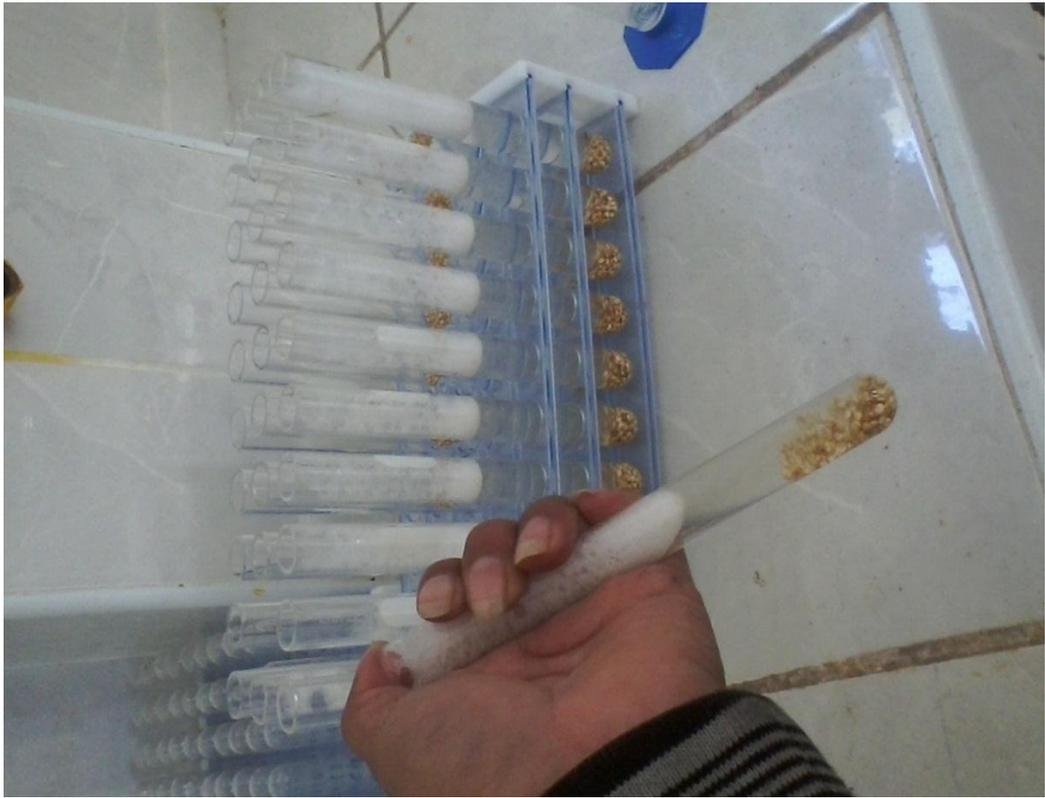
**Foto 12:** Agitando el tubo de ensayo para obtener la atura de la espuma.
