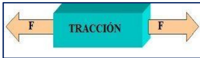
Figura 2: Esfuerzo de tracción Fuente: www.areatecnologia.com
