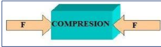
Figura 1: Esfuerzo de compresión Fuente: www.areatecnologia.com
