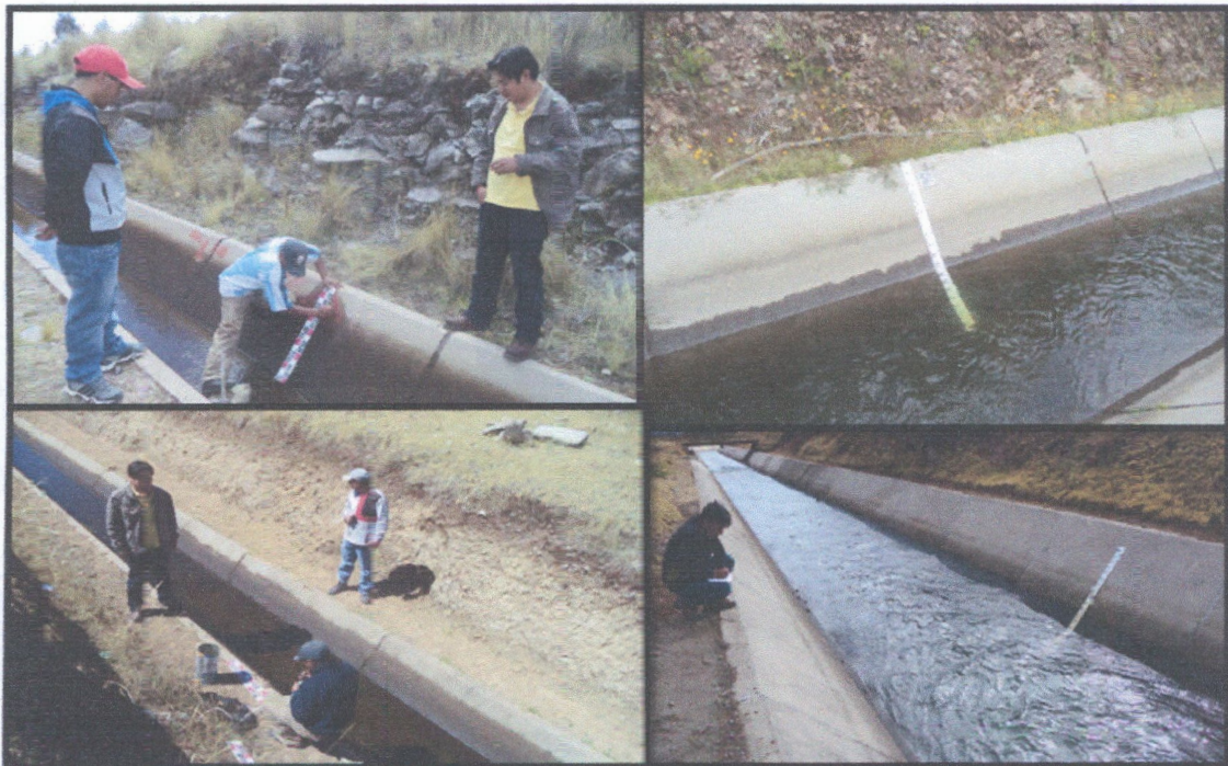
FIGURA .04 En la figura se observa colocación de miras para el control adecuado del caudal.
