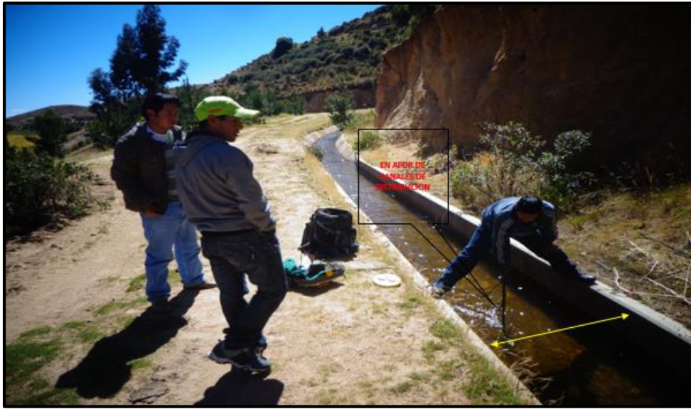
Figura 3. 6 Aforo en Canal de distribución.
