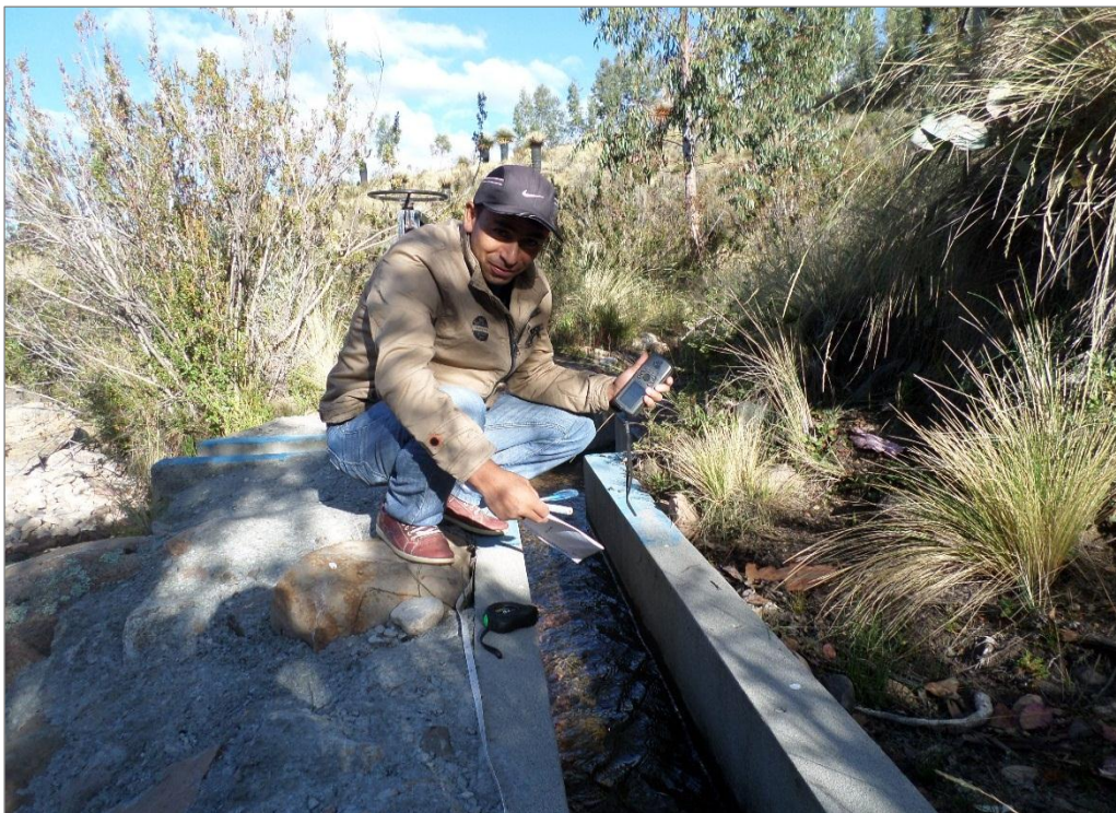
Foto 04: Vista fotográfica del aforo en canal existente de la quebrada Amaruyuq, el segundo afluente de la microcuenca
