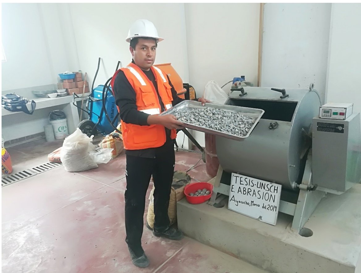
Figura C.2 Colocación del agregado grueso en la máquina de los Ángeles.
