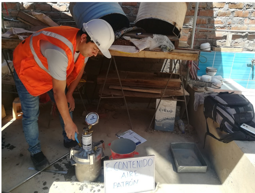
Figura 7 Inyectando agua por la válvula
