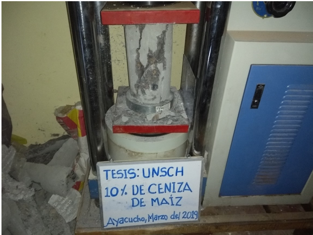
Figura C.15 Rotura de probetas con adición de 10% de ceniza de chala de maíz 28 días.
