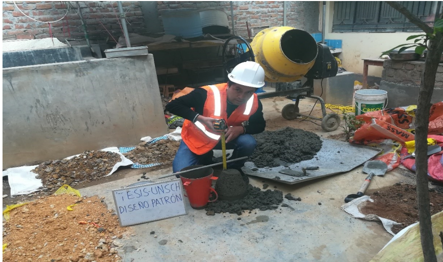
Figura 6 Medición de slump en el concreto patrón
