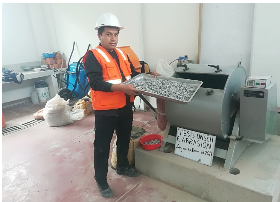
Figura 26 Colocación del agregado grueso en la máquina de los Ángeles Fuente: Elaboración propia
