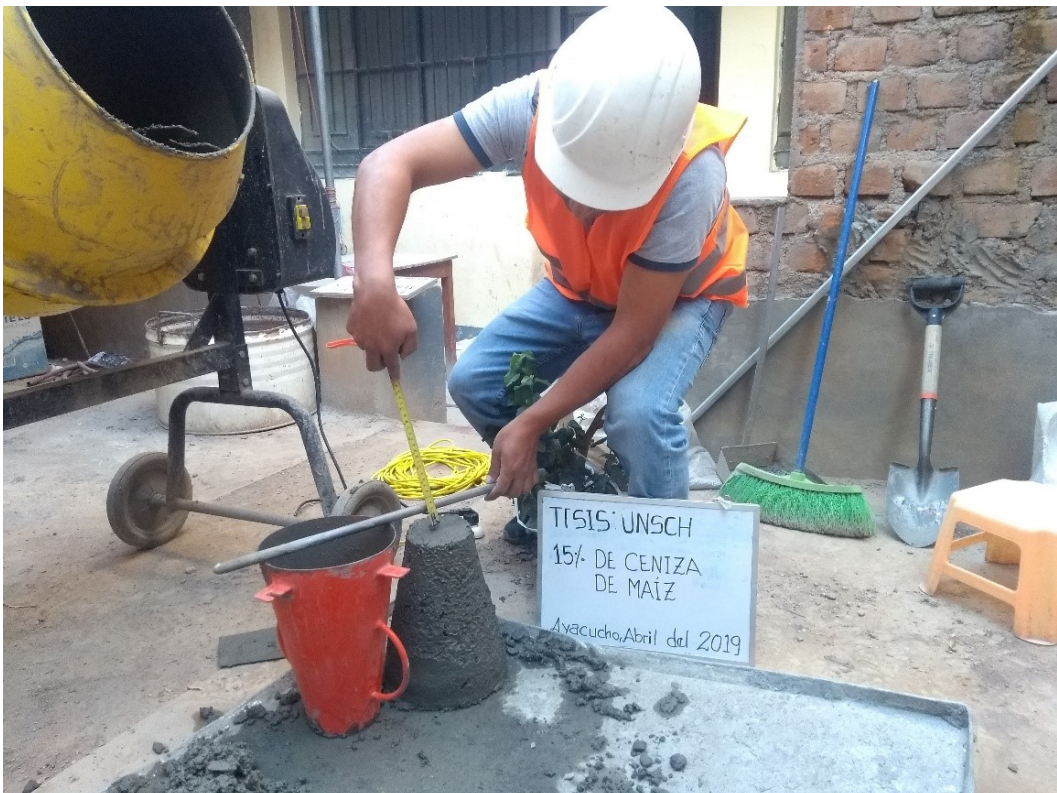
Figura C.10 Ensayo de asentamiento(Slump) con adición de 15% de ceniza de chala de maíz.
