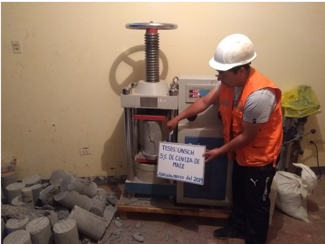
Figura C.14 Rotura de probetas con adición de 5% de ceniza de chala de maíz. Fuente: Elaboración propia
