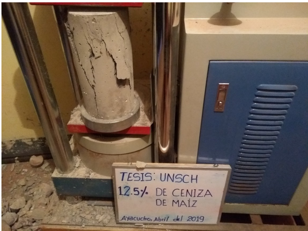
Figura C.16 Rotura de probetas con adición de 12.5% de ceniza de chala de maíz.
