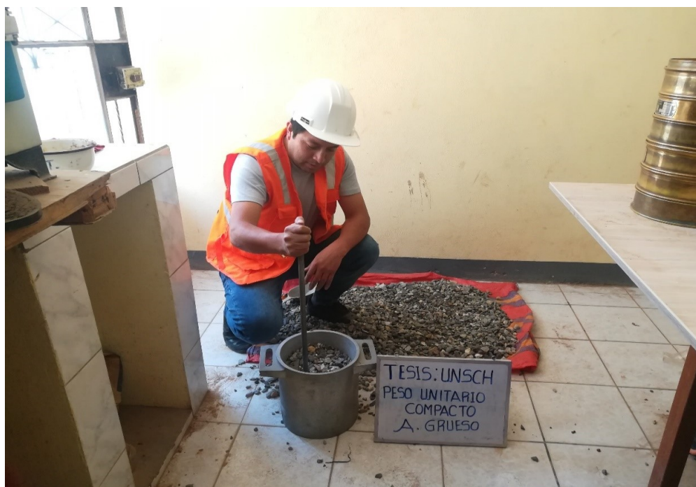
Figura 25 Apisonado con la barra compactadora del agregado grueso.
