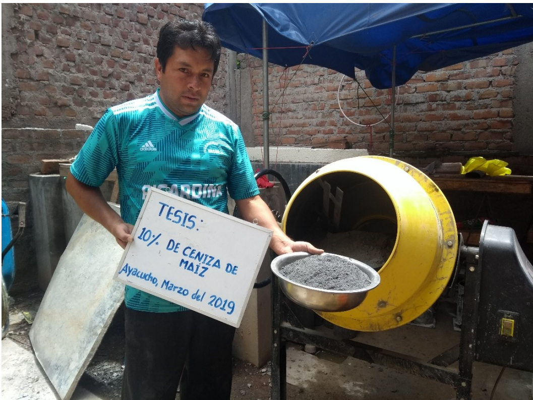
Figura C.8 Elaboración de mezcla de concreto con adición de 10% de ceniza de chala de maíz.
