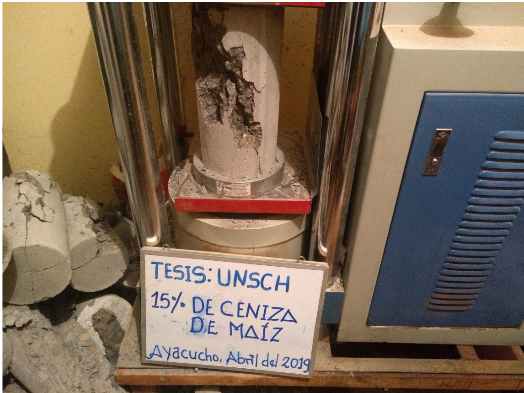
Figura C.17 Rotura de probetas con adición de 15% de ceniza de chala de maíz.
