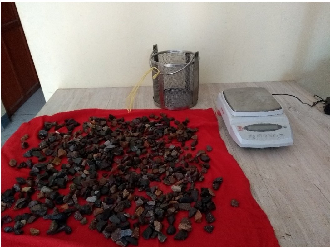
Figura C.6 Ensayo de absorción del agregado grueso. Fuente: Elaboración propia
