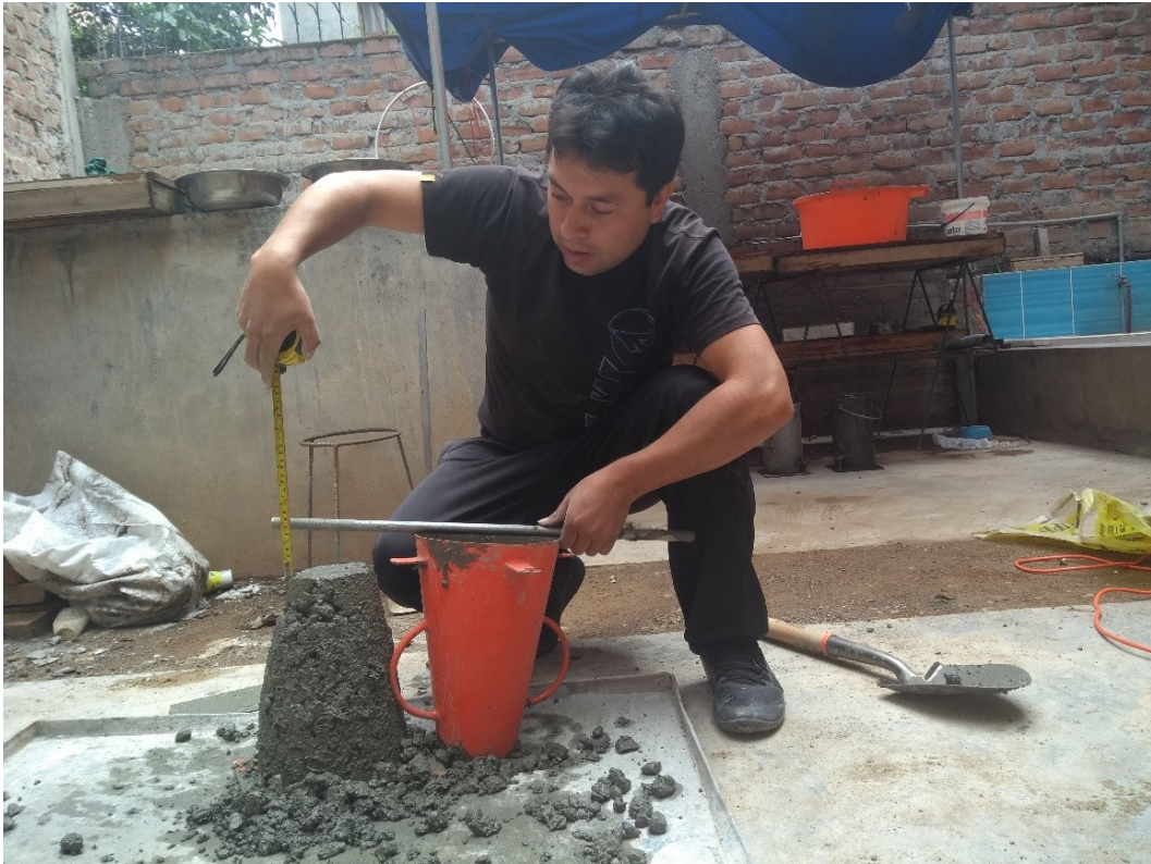
Figura C.9 Ensayo de asentamiento(Slump) del concreto patrón.
