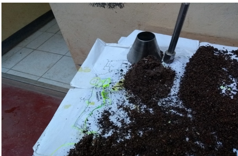
Figura 16 Verificación del estado saturado superficialmente seco del agregado fino
