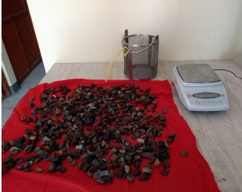
Figura 22 Escurrimiento del agua y esparcido del agregado Grueso sobre la franela Fuente: Elaboración propia
