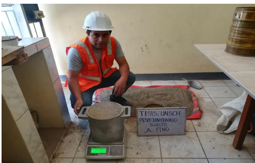
Figura 17 Enrasado y pesado del recipiente con la muestra del agregado fino
