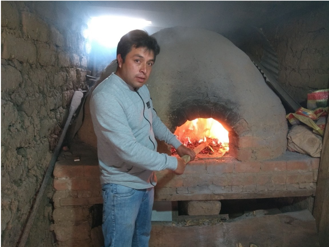
Figura C.21 Quemado de chala de maíz en el horno artesanal.
