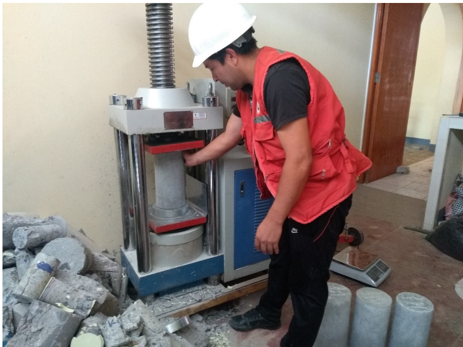
Figura 8 Rotura de briquetas en la prensa hidráulica
