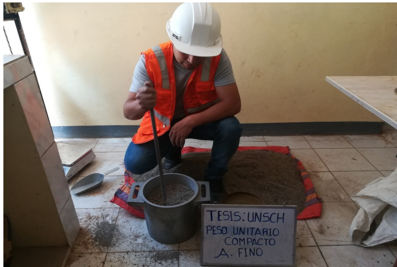
Figura 18 Apisonado con la barra compactadora del agregado fino.
