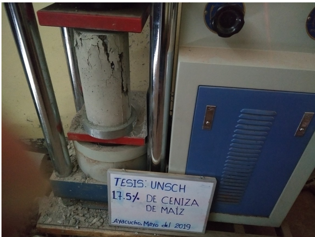
Figura C.18 Rotura de probetas con adición de 17.5% de ceniza de chala de maíz.
