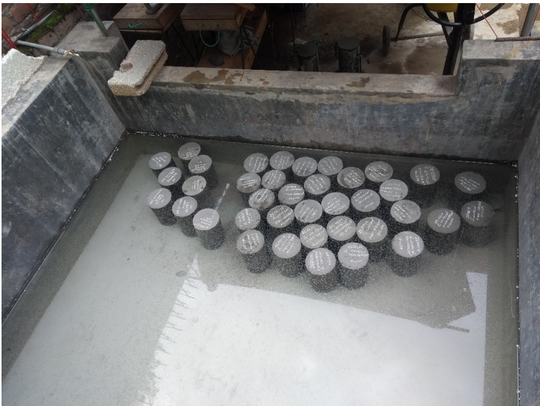
Figura C.12 Curado de probetas
