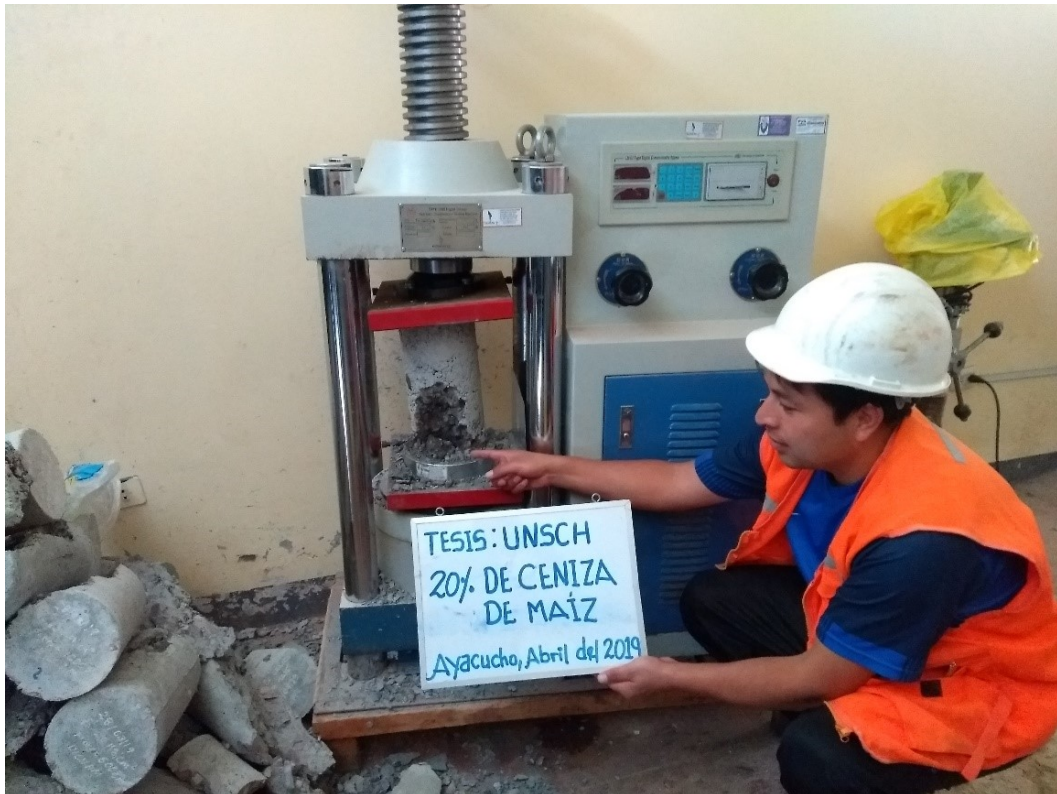
Figura C.19 Rotura de probetas con adición de 20% de ceniza de chala de maíz.
