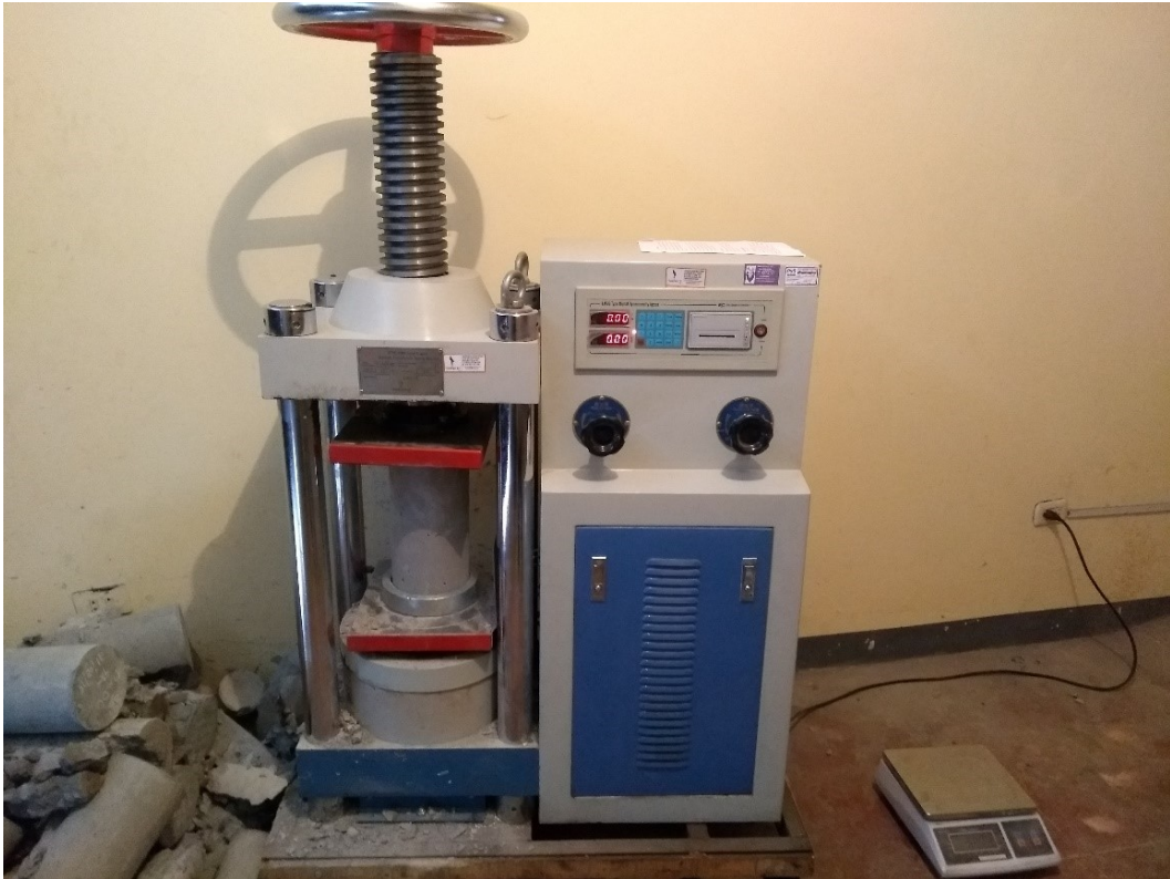
Figura C.13 Rotura de probetas del concreto patrón. Fuente: Elaboración propia
