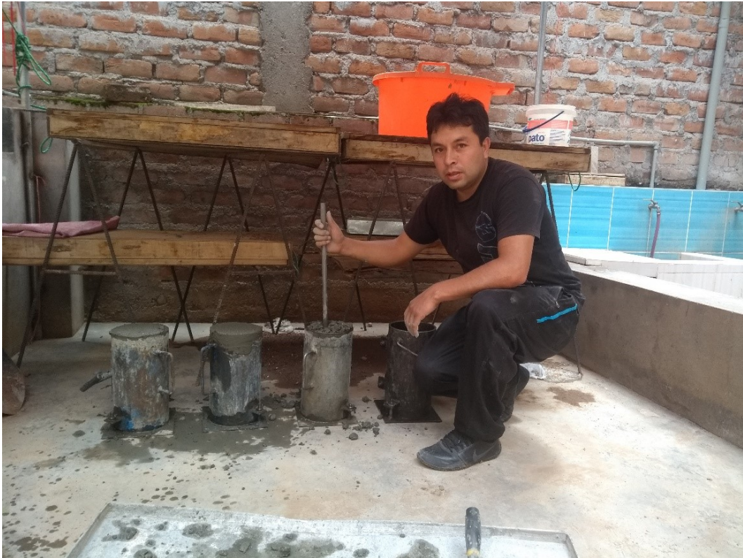
Figura C.11 Colocación de la mezcla de concreto en las probetas.
