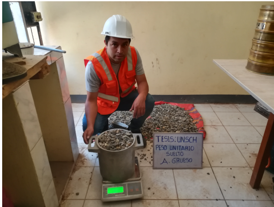
Figura 24 Pesado del recipiente con la muestra del agregado grueso.
