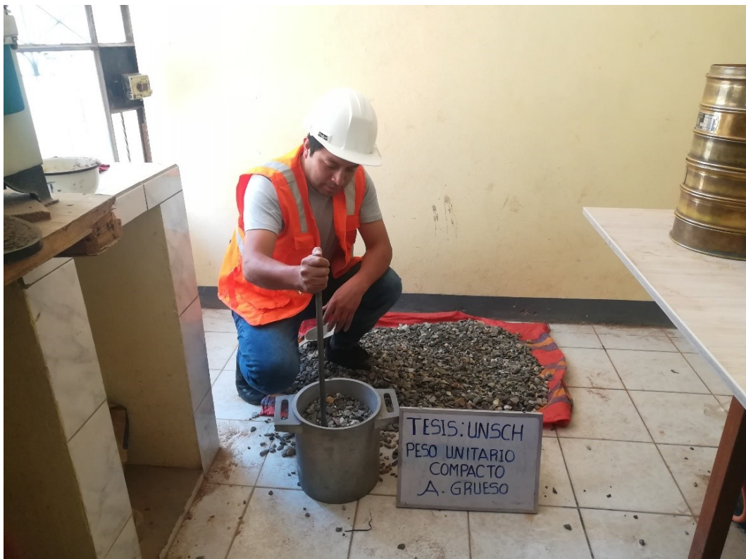
Figura C.4 Apisonado de la segunda capa del agregado grueso con la barra compactadora. Fuente: Elaboración propia
