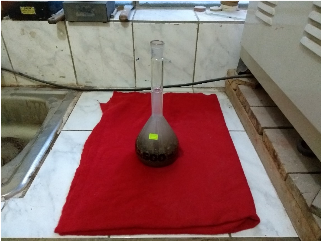
Figura C.5 Ensayo de peso específico y absorción del agregado fino. Fuente: Elaboración propia
