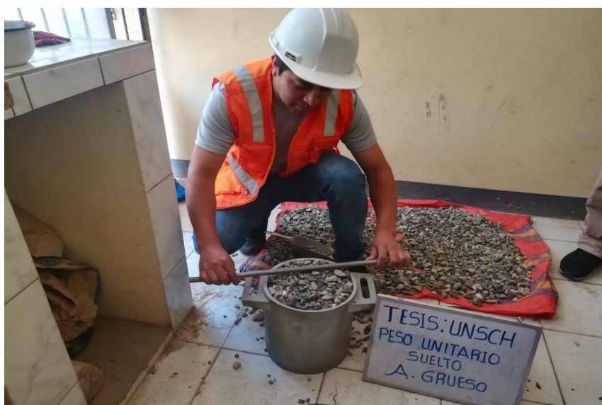
Figura 23 Enrasado del molde metálico con agregado grueso.
