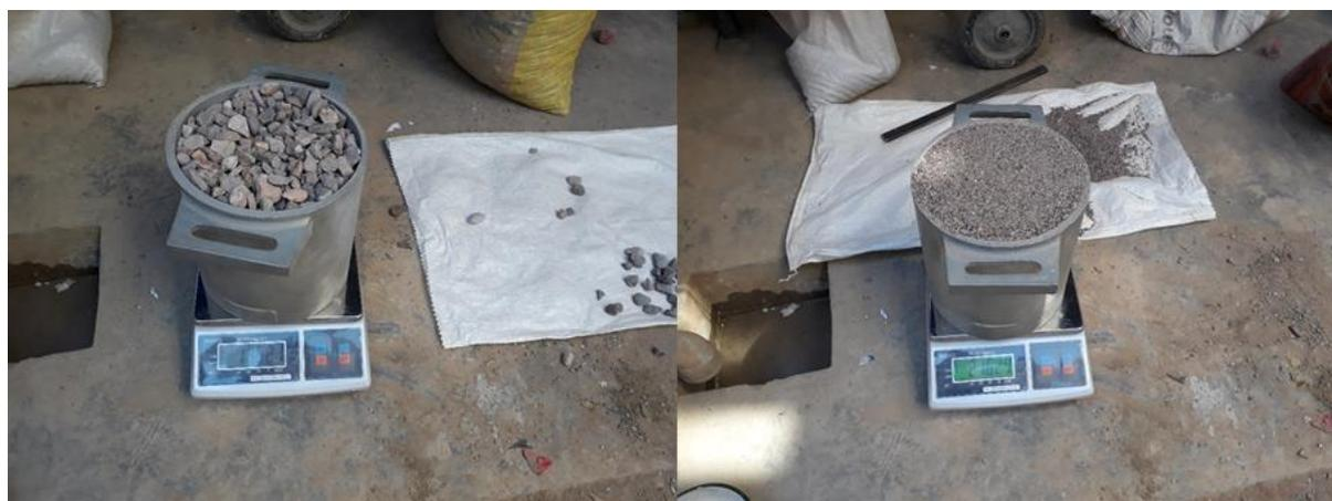
Figura 43: Medición del peso unitario tanto del agregado grueso y agregado fino, los ensayos se hacen tanto para peso unitario suelto y compacto, el ensayo se hizo en tres capas para lo que es peso unitario compacto para ambos
