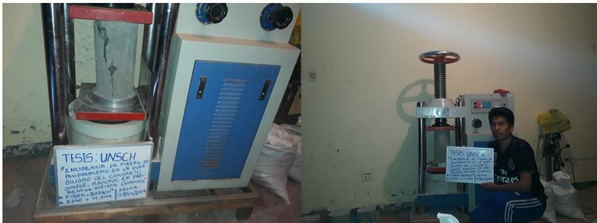
Figura 57: Rotura a la compresión de concreto, fibra de polipropileno 500g, edad 14 días
