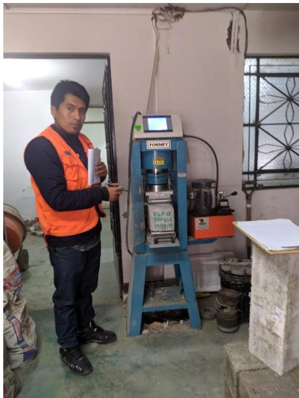
Figura 71: Equipo para la rotura a la flexión en vigas.
