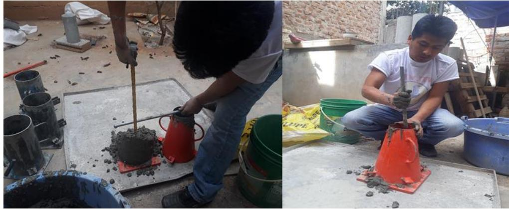
Figura 11: Ensayo del asentamiento, medición del asentamiento
