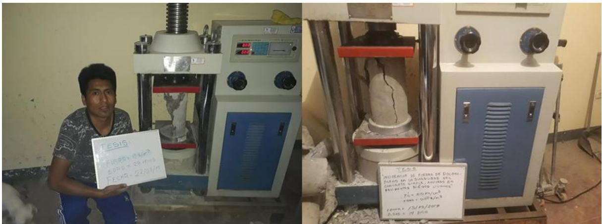
Figura 51: Rotura a la compresión de concreto, de probetas en prensa hidráulica sin fibra edad 14 y 28 días.
