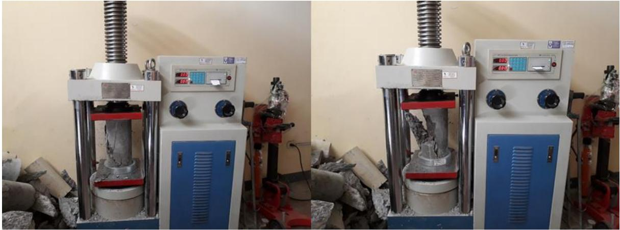
Figura 50: Rotura a la compresión de concreto, de probetas en prensa hidráulica, sin fibra edad 7 días.
