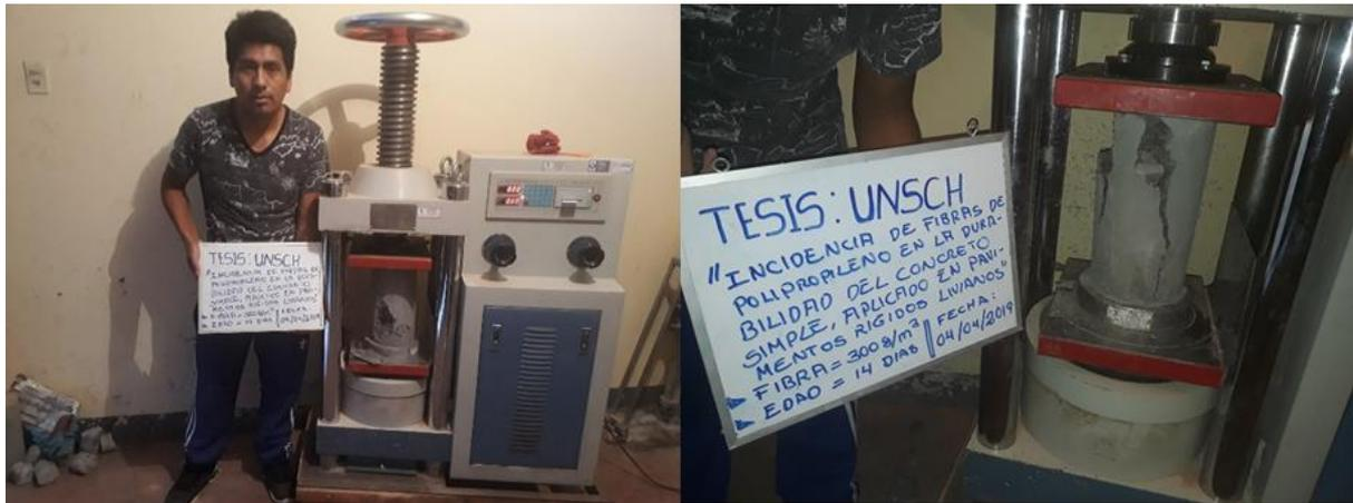
Figura 52: Rotura a la compresión de concreto, de probetas en prensa hidráulica, adicionando fibra de polipropileno 300g, edad 14 días.
