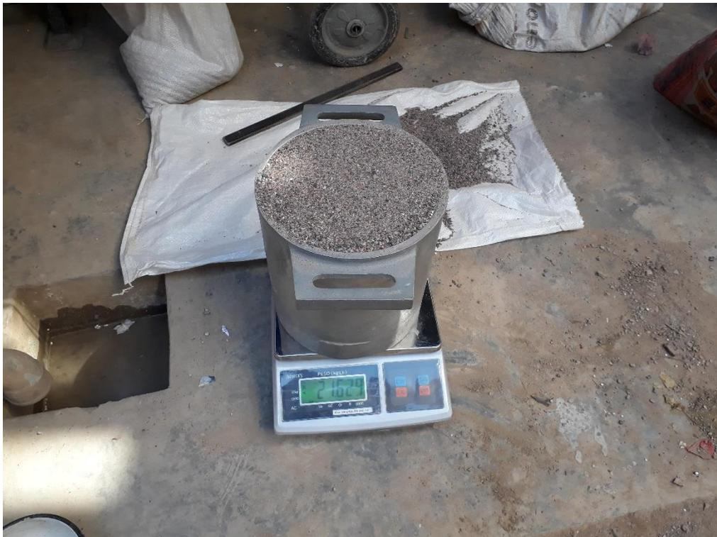
Figura 28: Molde para determinar el peso unitario del agregado fino
