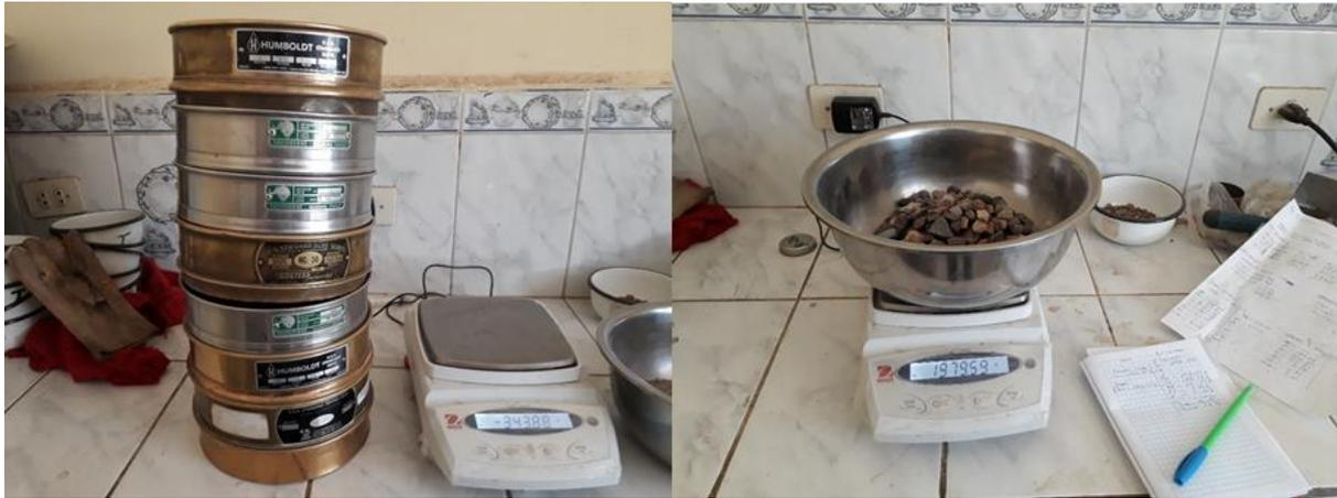
Figura 44: Ensayo de granulometría con los tamices que se muestra en la figura, la misma que se hace para agregado fino.
