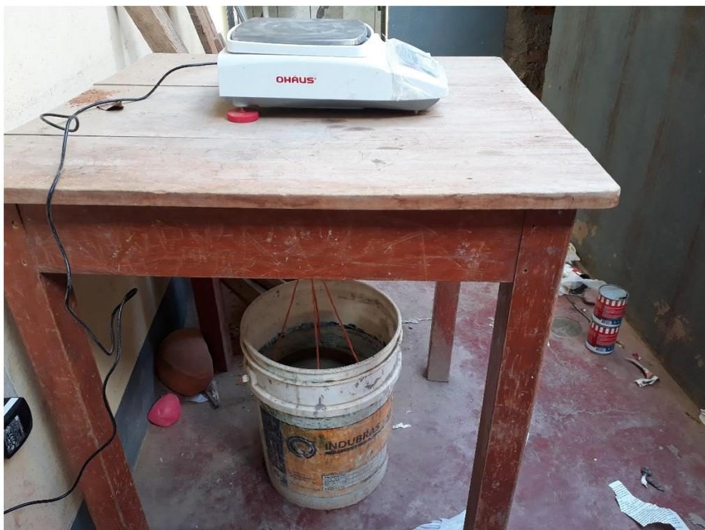
Figura 32: Equipo para ensayo de peso específico del agregado grueso
