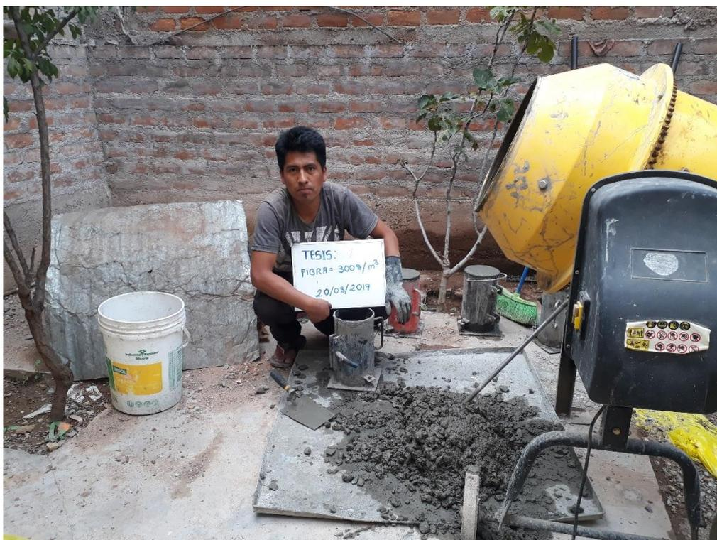
Figura 48: Preparado del concreto adicionando fibra 300g por metro cubico de concreto
