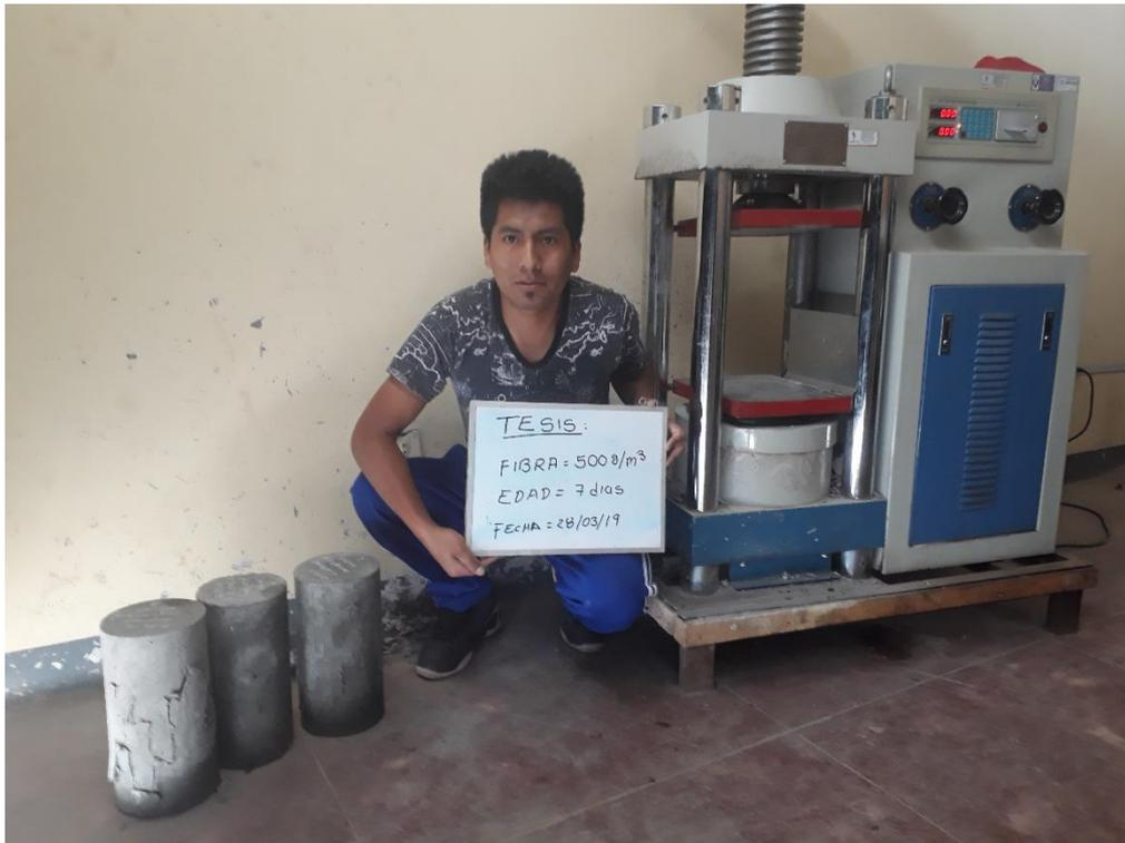
Figura 56: Rotura a la compresión de concreto, fibra de polipropileno 500g, edad 7 días
