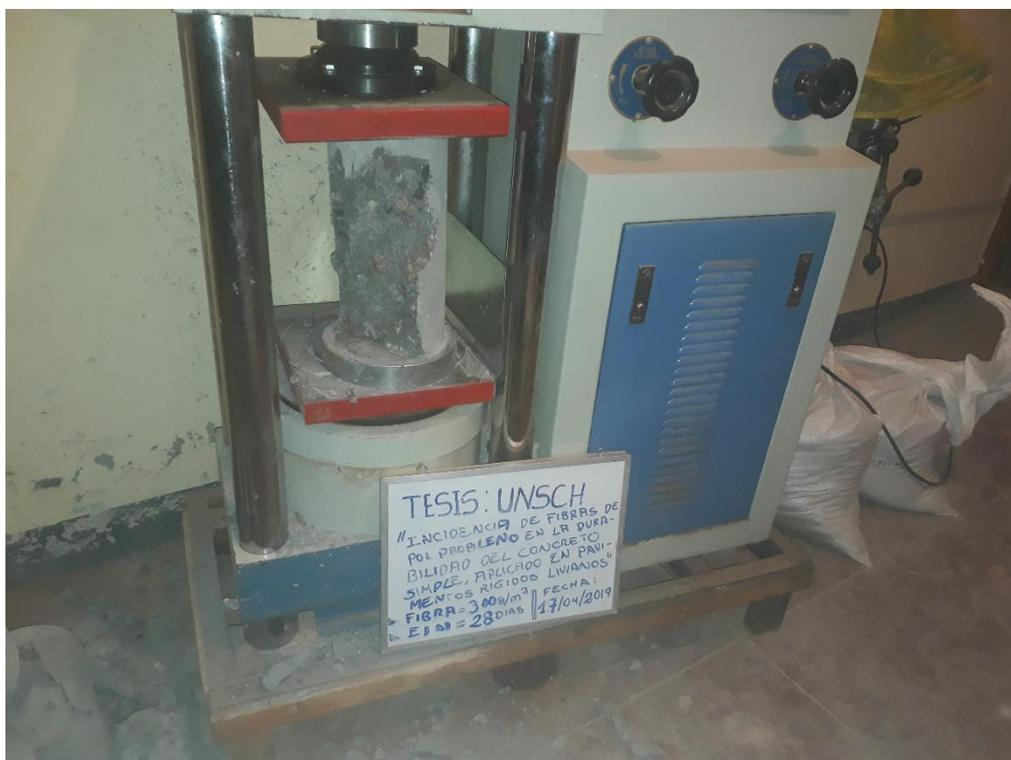
Figura 55: Rotura a la compresión de concreto, de probetas, fibra 300g, edad 28 días
