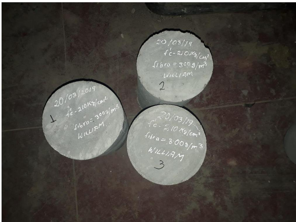
Figura 53: Testigos de concreto, adicionados con fibra de polipropileno 300g
