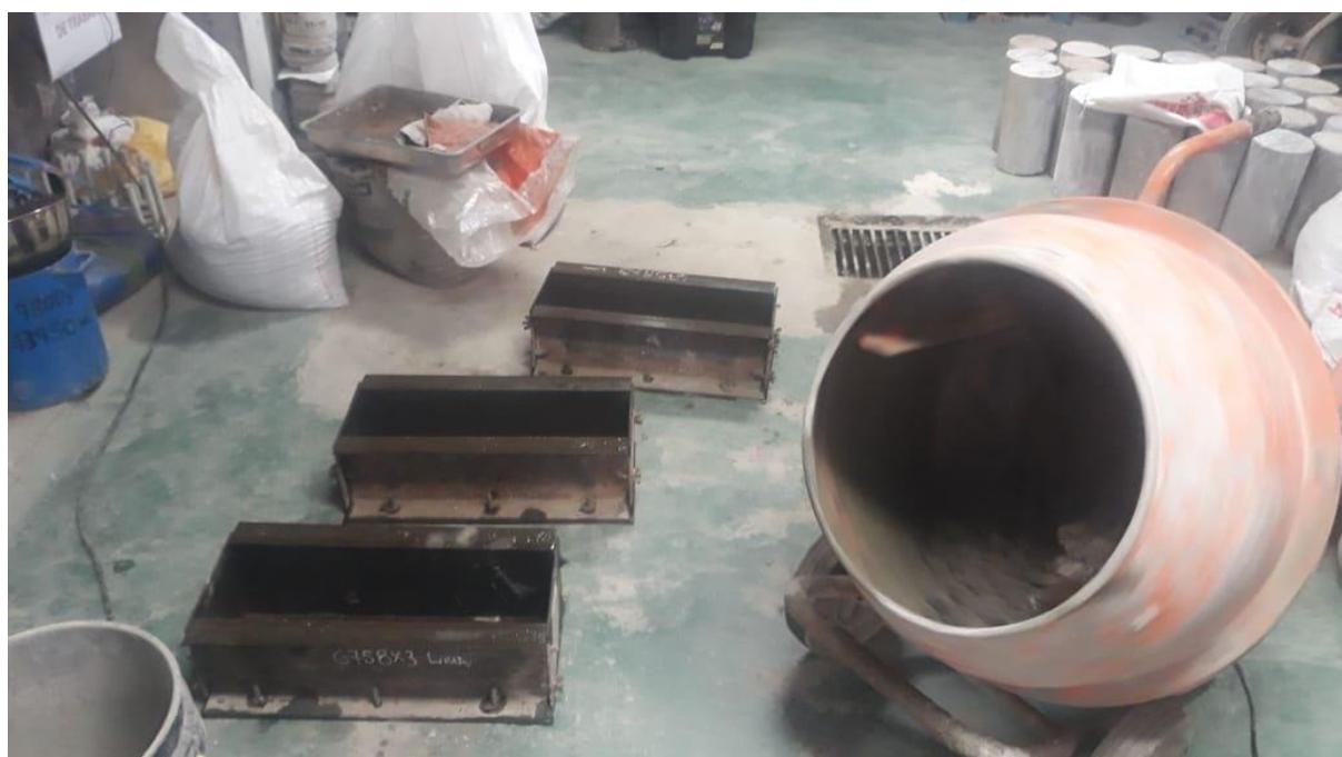
Figura 67: Moldes metálicos vigas de 15x15x50cm.
