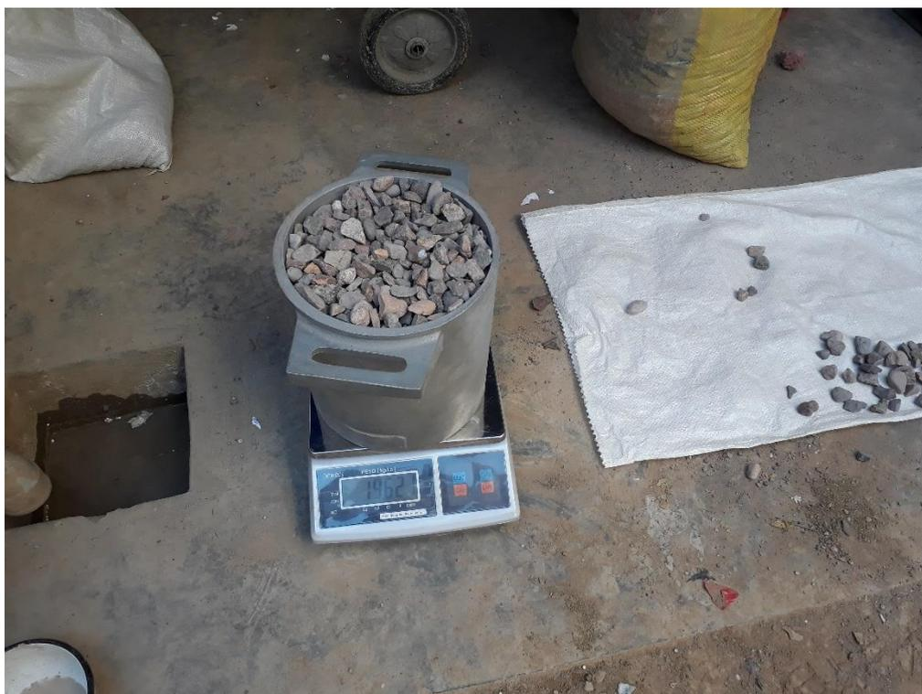
Figura 31: Molde para determinar el peso unitario del agregado grueso
