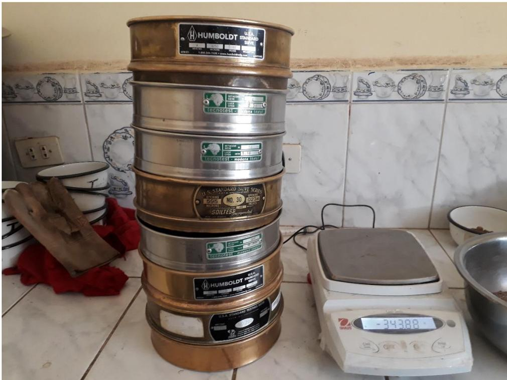
Figura 30: Tamices N° 1" depósito de fondo granulométrico del agregado grueso
