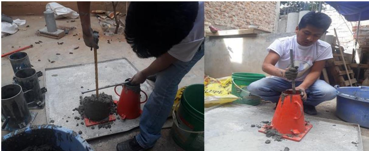
Figura 47: Preparado del concreto en el cono de Abraham y medición del slump en el laboratorio
