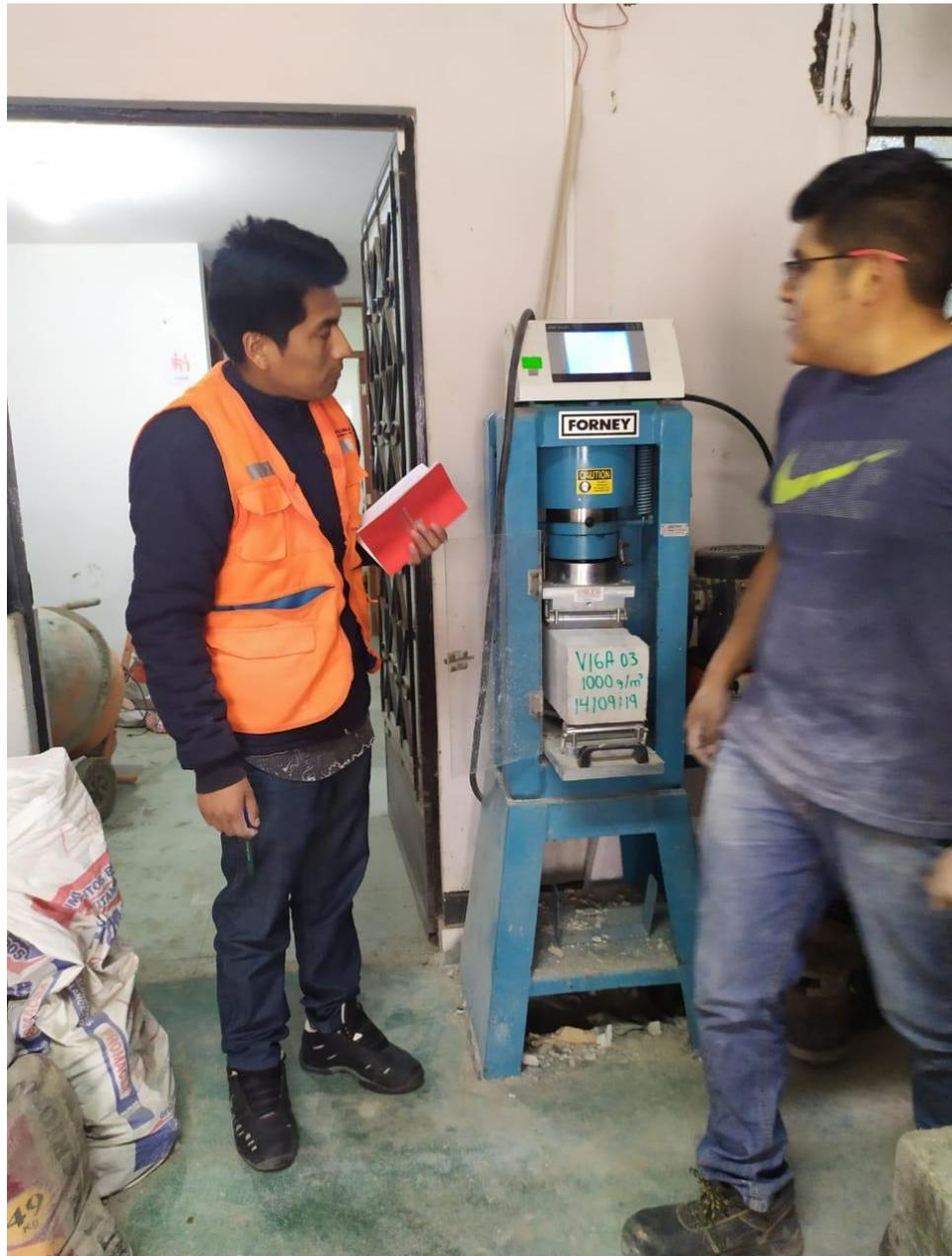
Figura 18: Ensayo de resistencia a la flexión simplemente apoyada en los tercios de la luz.
