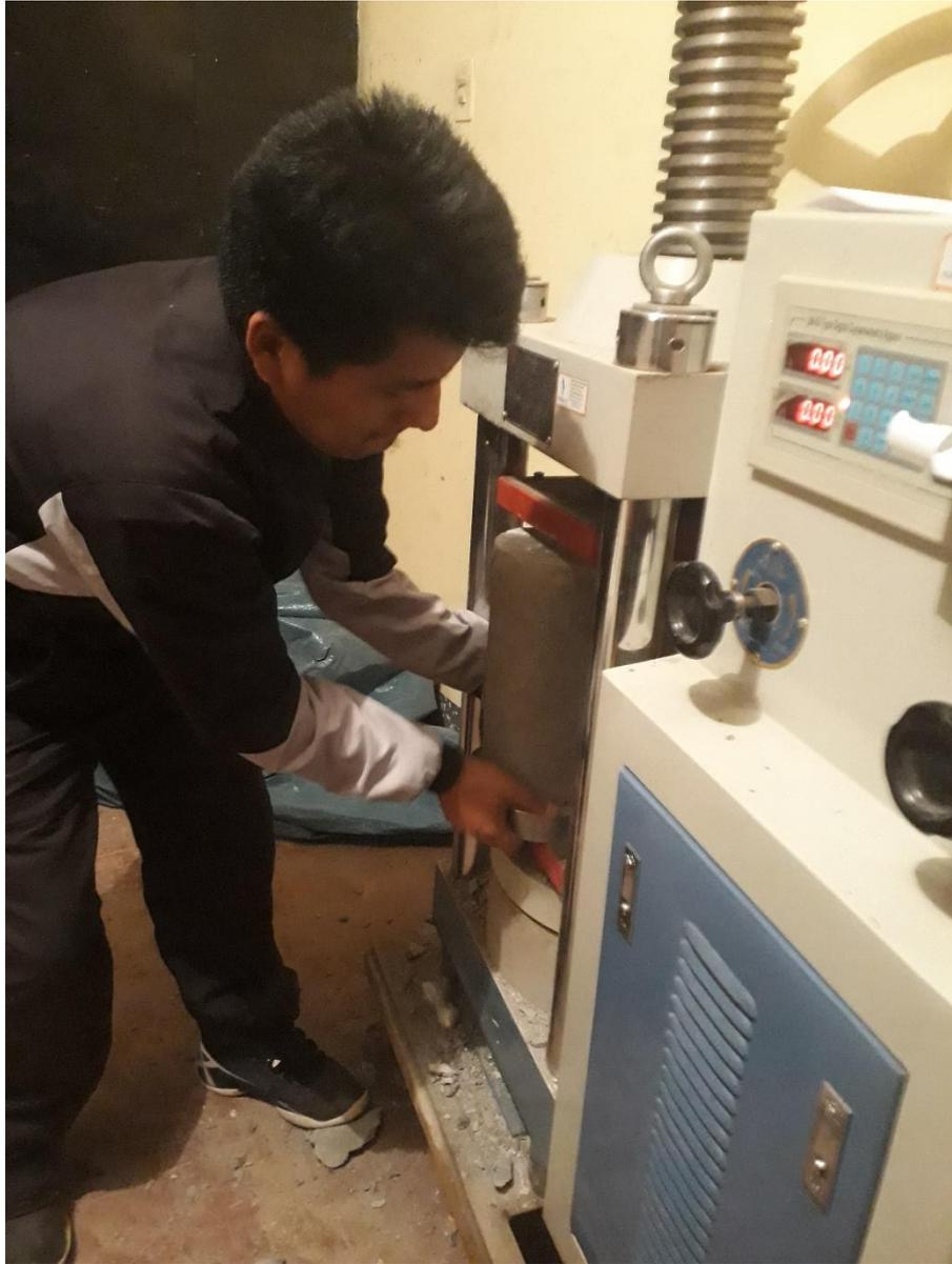
Figura 12: Equipo para medir la resistencia a la compresión, prensa hidráulica
