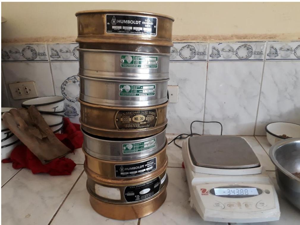
Figura 27: Tamices N° 3/8 depósito de fondo granulométrico del agregado fino
