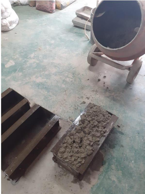
Figura 68: Preparación de concreto en las vigas metálicas
