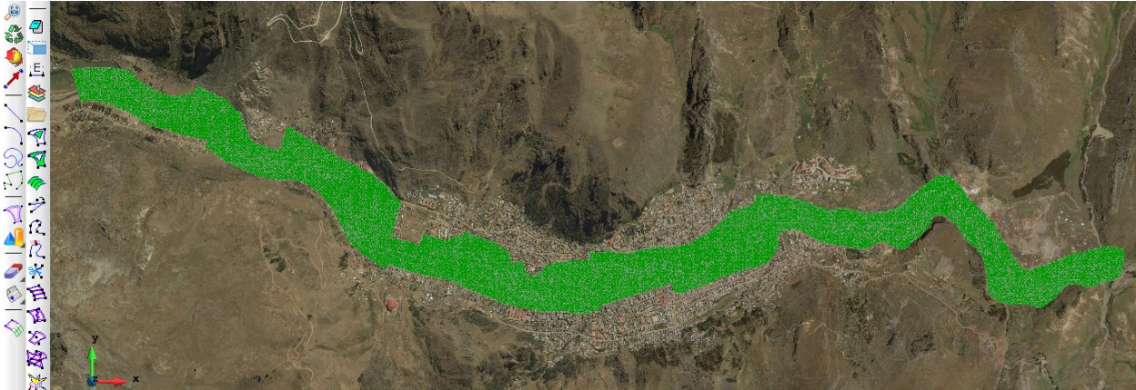
Figura 4.31 Malla no Estructurada, Software Iber.
