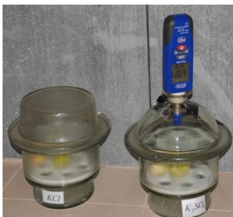
Figura 3. Verificación de Humedad relativa de cámaras
