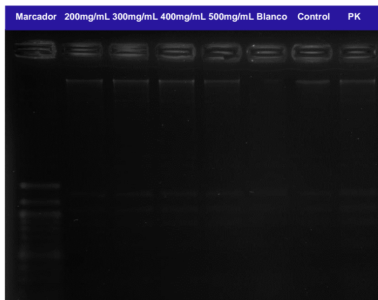
Figura 5: Ensayo genotóxico in vitro del extracto etanólico del bulbo de Allium sativum L. “ajo” a concentraciones de 200, 300, 400 y 500 mg/mL, frente a ADN genómico de Staphylococcus sp. incubado a 37°C durante una hora. C.I.B.M.B.- UNSCH. Ayacucho 2017.
