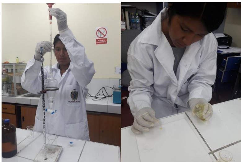
Preparación del eluyente BAW (butanol: ácido acético: agua (4:1:5)) Sembrado de la muestra y el estándar (quercetina) en la placa con Silicagel
