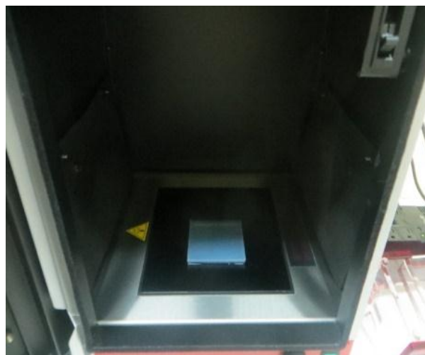
Cámara oscura del equipo registrador de imágenes Biometra UVsolo TS
