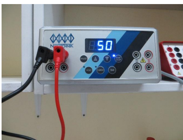
Instalación y programación de la cámara de electroforesis a 50 v por 3 horas
