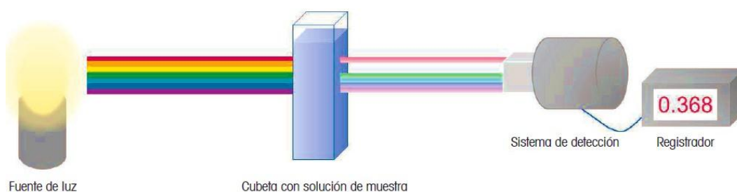
Figura 12. Principio de medición en espectroscopia UV/VIS. 40
