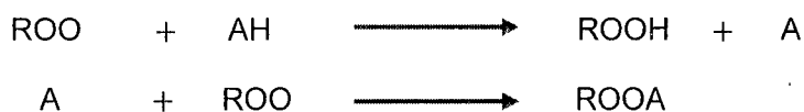
Figura 4. Mecanismos de reacción por transferencia de electrones y transferencia de átomos de hidrógeno.
