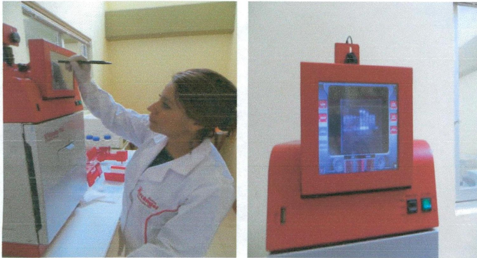
Figura 17. Sistema de registrador de imágenes Biometra UV solo TS del gel de agarosa con los productos de XL-PCR del gen CYP2D6 de ADN genómico de linfocitos humano.
