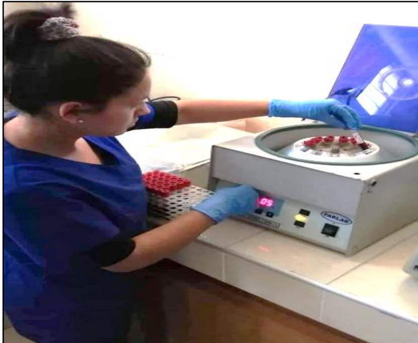
Foto 9. Tesista utilizando la centrifuga para la obtención del suero dentro del laboratorio del Centro de Salud San Martin.
