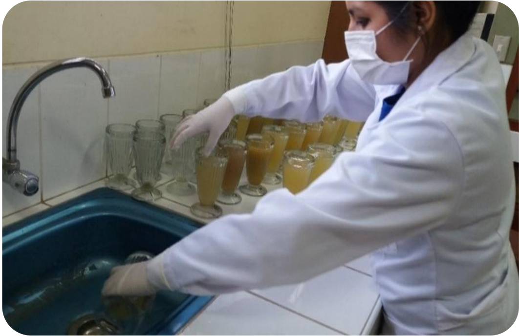
Anexo 8. Vertiendo el contenido del vaso para la obtención del sedimento.
