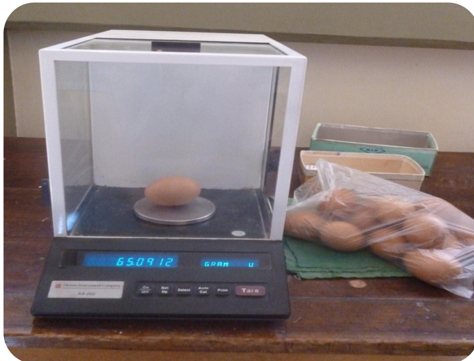
Anexo 5. Fotografía de la balanza analítica pesando las muestras de huevos de gallinas colectados. Ayacucho 2019.
