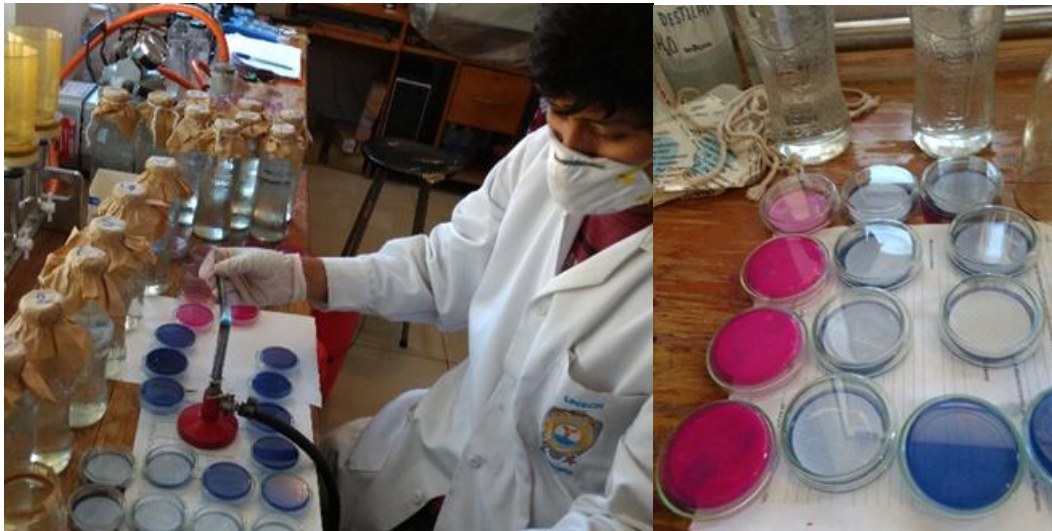
Cuantificación de coliformes totales y termotolerantes por la técnica de filtro de membrana
