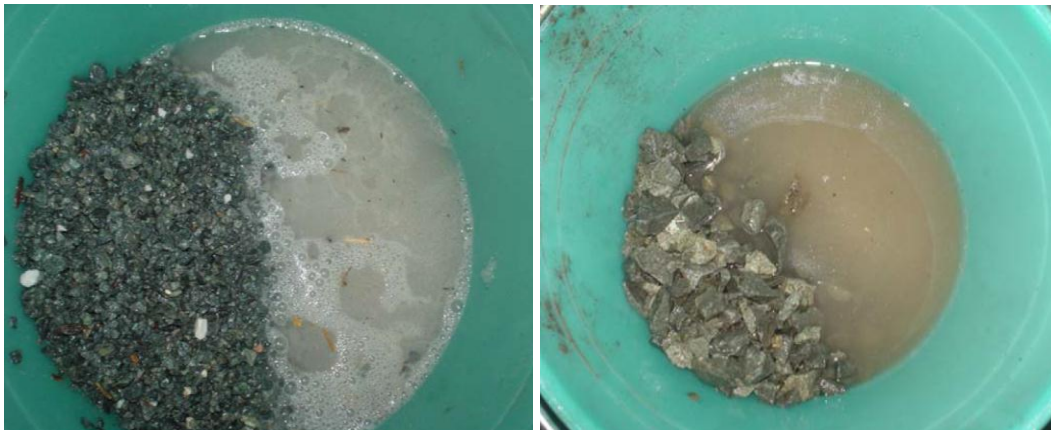
a) Lavado de gravilla y grava
