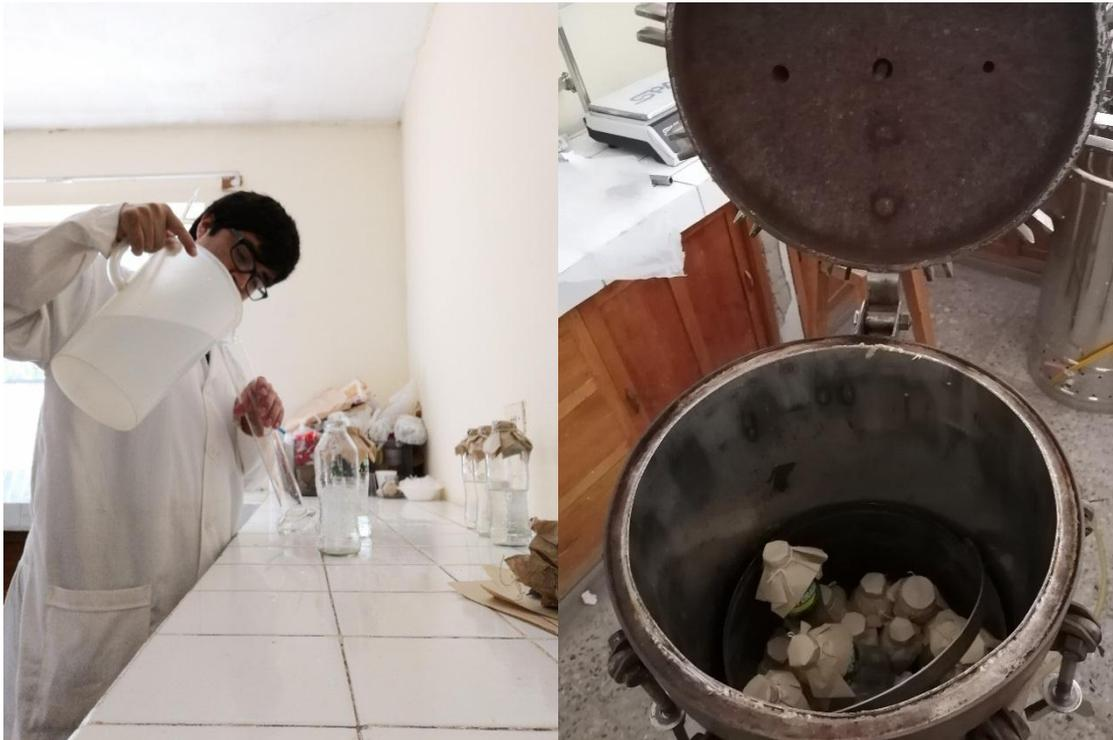
**Fotografía 8.** Izquierda: Preparación de la solución salina. Derecha: Esterilización de la solución salinas y otros materiales que se usará.
