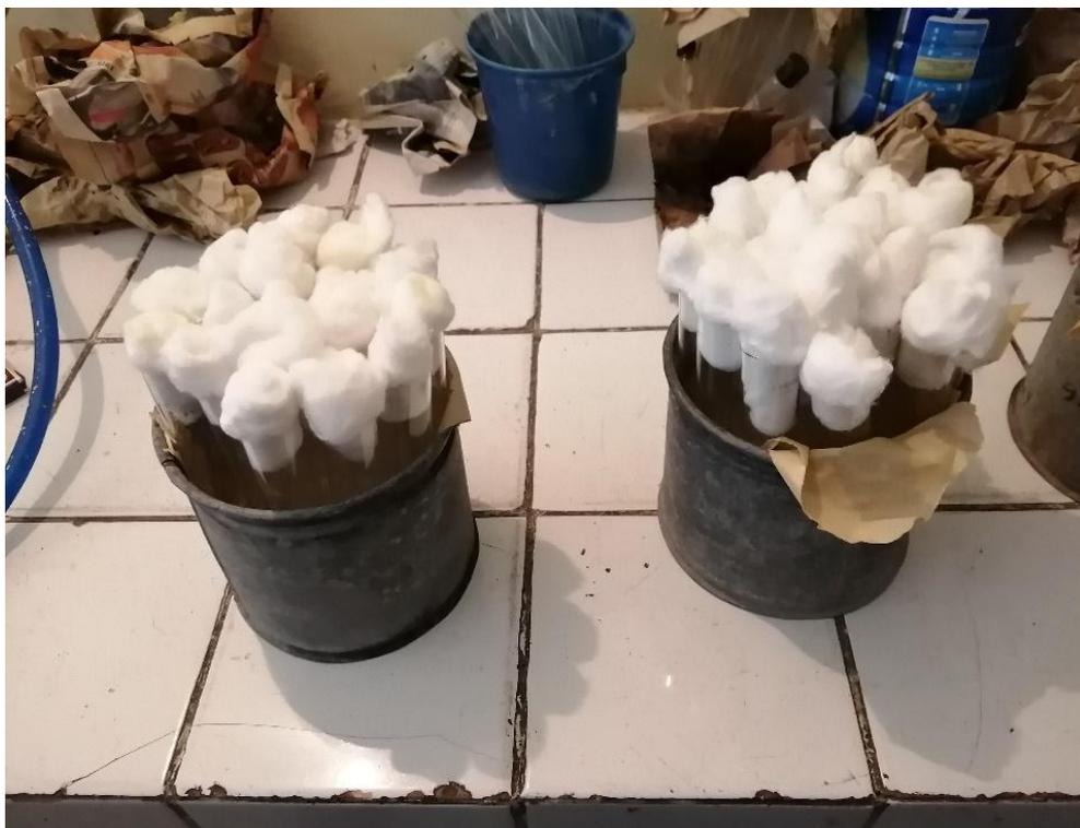
**Fotografía 7.** Colocación de los tubos con medio Jensen en latas de metal para su esterilización en la autoclave.
