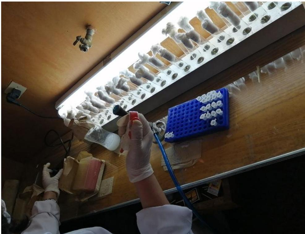
**Fotografía 13.** Toma de 100  $\mu\text{l}$  de dilución  $10^{-3}$  a los tubos EPENDORF (900  $\mu\text{l}$ ) dilución  $10^{-4}$ , agitación e inoculación de *Rhizobium leguminosarum* bv *trifoli* en plantas de trébol rojo.
