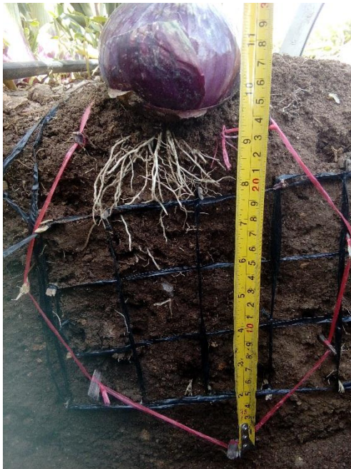
27. Evaluación del bulbo húmedo del goteo (profundidad y radio).
