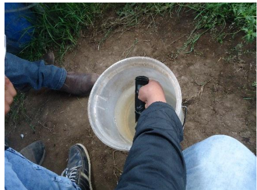
29. Medición de pH y CE del agua del C.E. Canaán - Ayacucho
