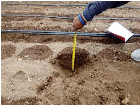
27. Evaluación del bulbo húmedo del goteo (profundidad y radio).
