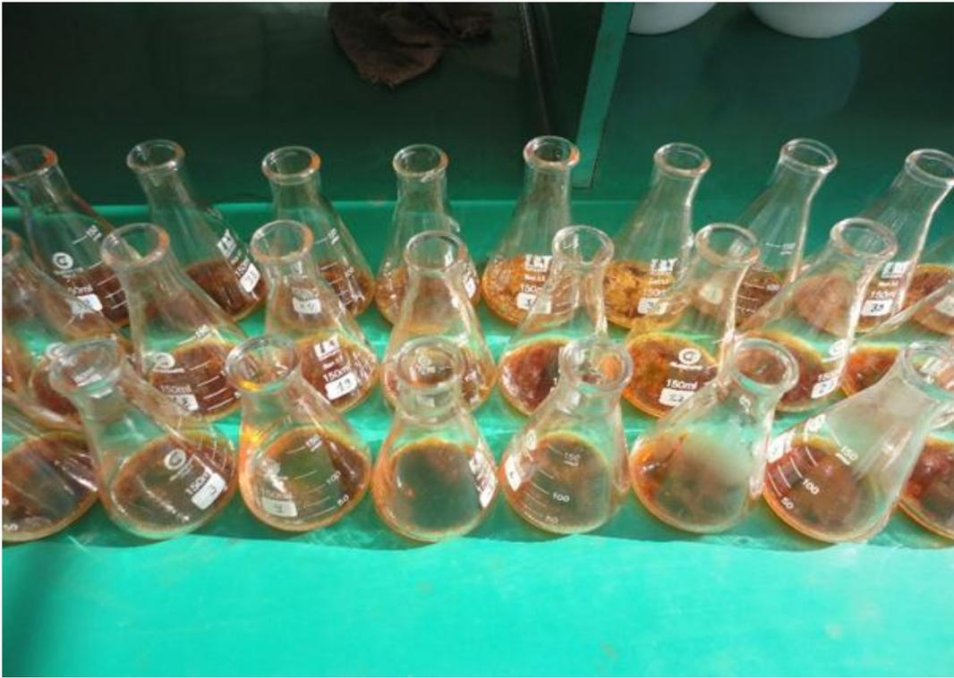
**Foto 13.** Proceso de inicio de digestión ácida por vía húmeda
