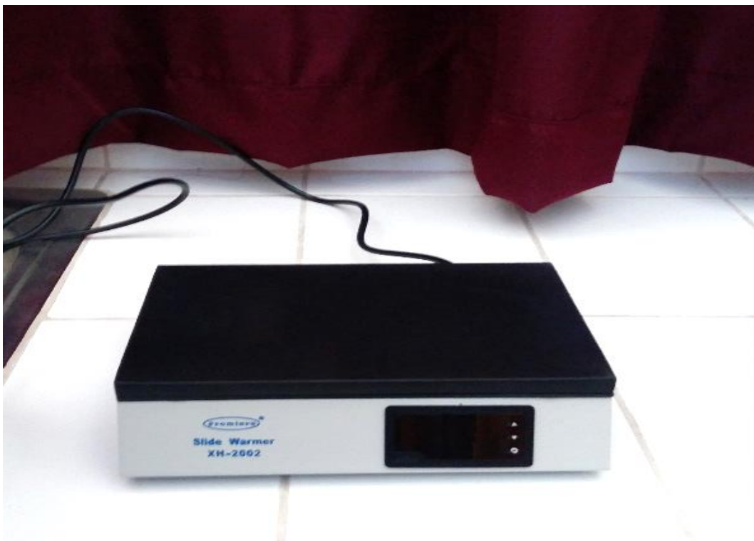
Foto 6. Platina termina para mantener temperatura adecuada para los embriones y medios.
