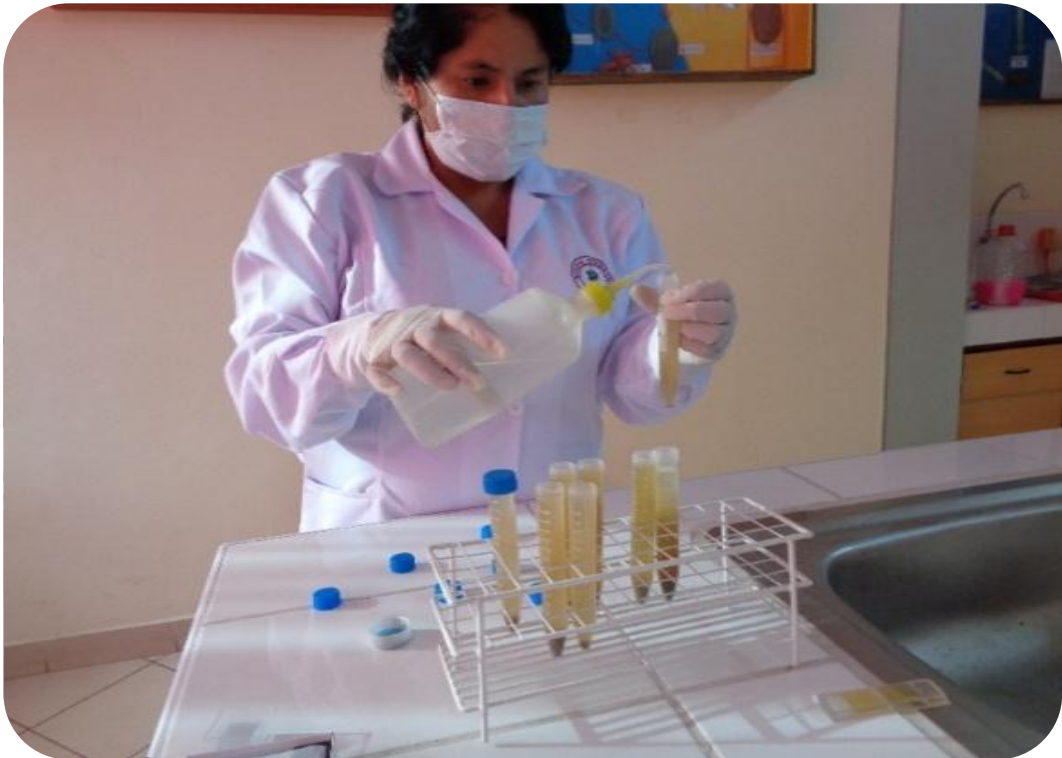
Foto 23. Llenado con la solución salina hasta formar menisco
