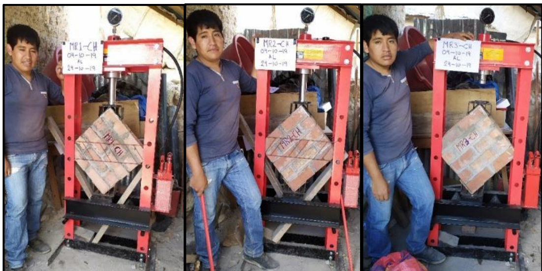
Figura 2.39. Ensayo de resistencia al corte en muretes de ladrillos King Kong 15 huecos
