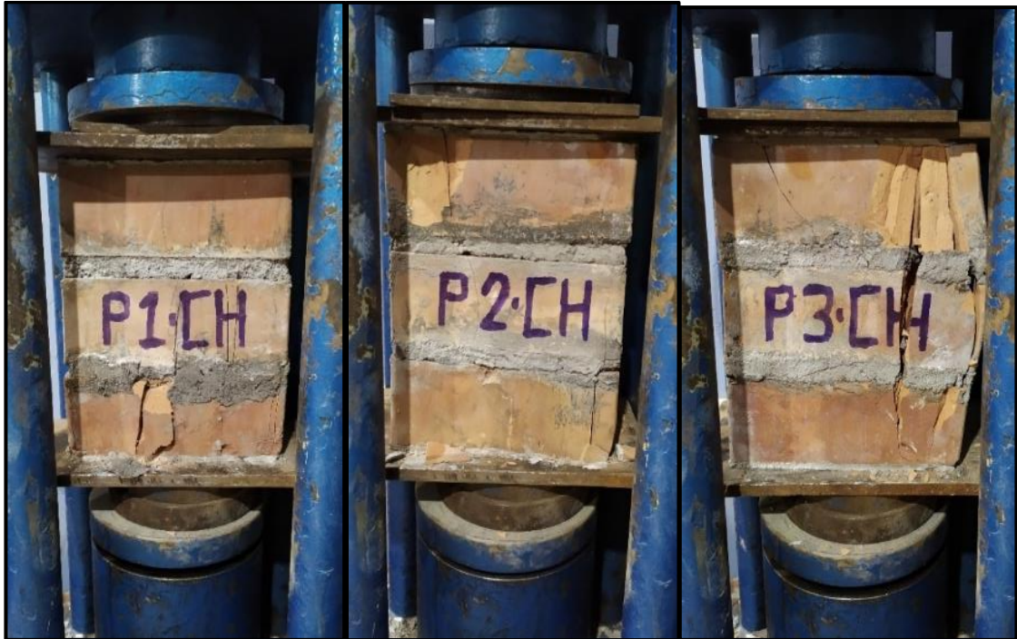
Figura 2.35. Pilas de ladrillos King Kong 15 huecos después del ensayo de resistencia a la compresión
