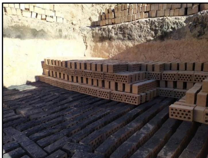
Figura 2.14. Colocación y cobertura con carbón mineral en horno para la cocción de ladrillos
