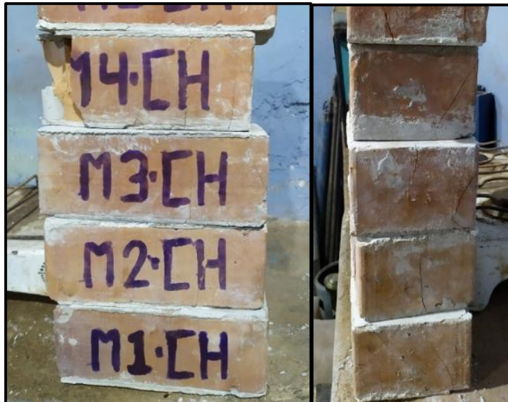
Figura 2.31. Unidades King Kong 15 huecos después del ensayo de resistencia a la compresión
