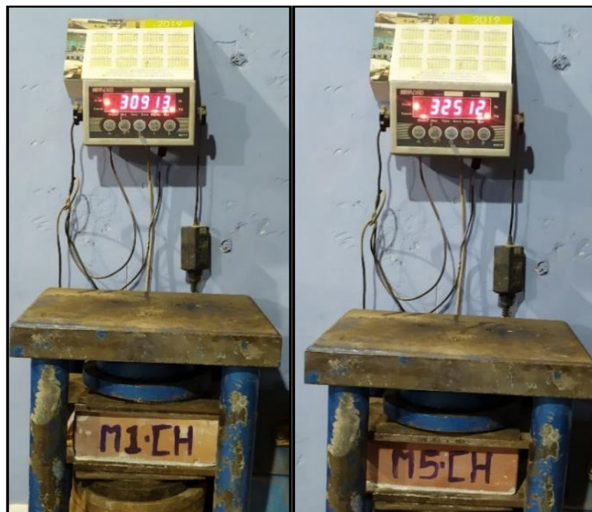
Figura 2.30. Ensayo de resistencia a la compresión en unidades King Kong 15 huecos
