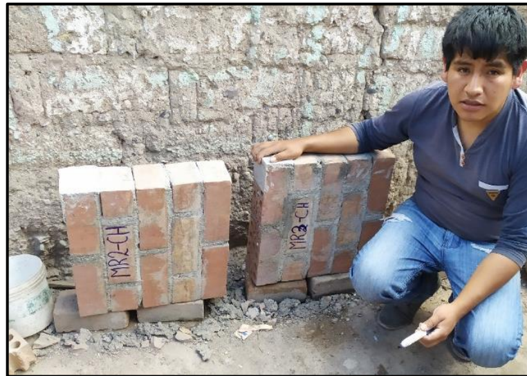
Figura 2.38. Muretes preparados y refrendados para el ensayo de resistencia al corte
