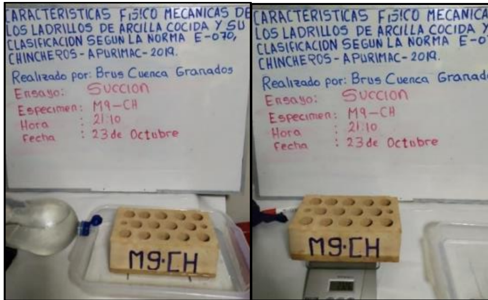
Figura 2.23. Ensayo de succión y el posterior pesado de la unidad con humedad
