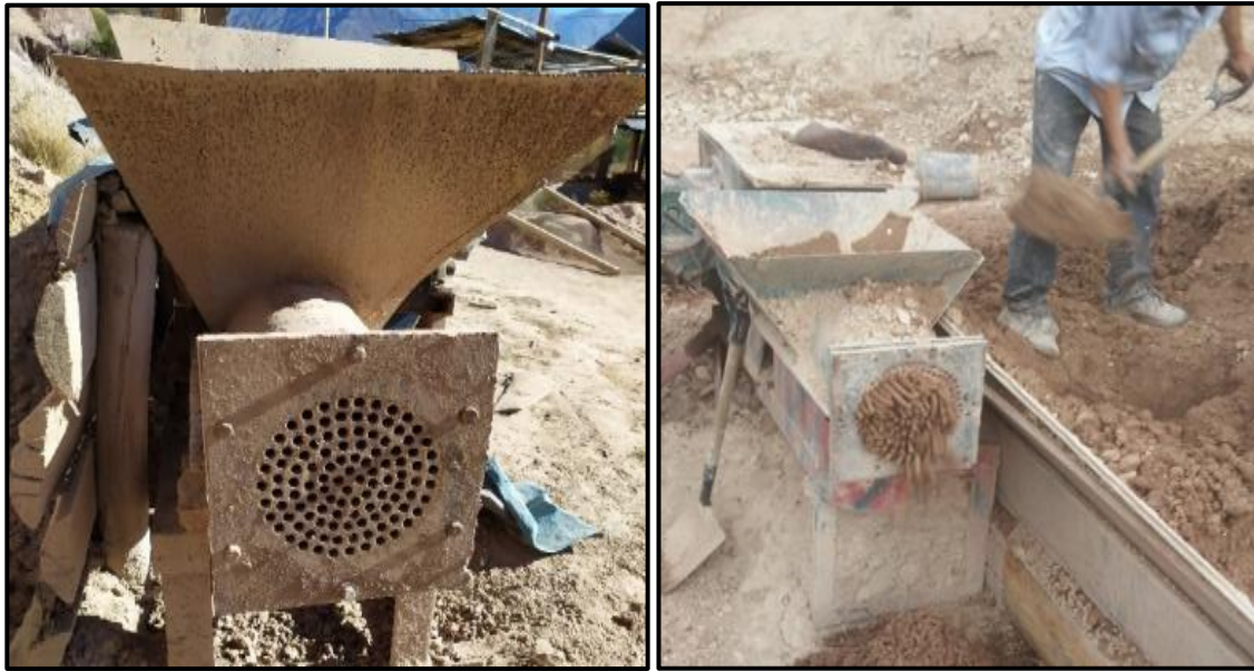
Figura 2.8. Izquierda: Máquina de triturado de arcilla, Derecha; Actividad de trituración de arcilla
