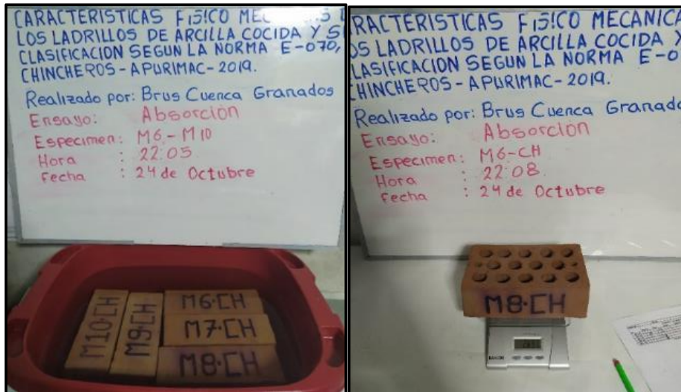
Figura 2.24. Se muestra la saturación de las unidades y el pesado de las mismas
