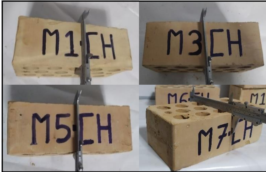
Figura 2.20. Toma de medidas de los ladrillos en el ensayo de variación dimensional
