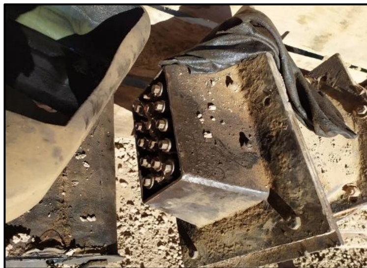
Figura 2.10. Molde para la fabricación de ladrillos King Kong 15 huecos (0.22 x 0.12 x 0.08 m)
