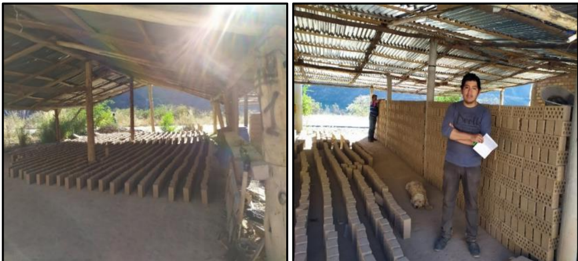
Figura 2.13. Secado y apilamiento de unidades King Kong 15 huecos fabricadas
