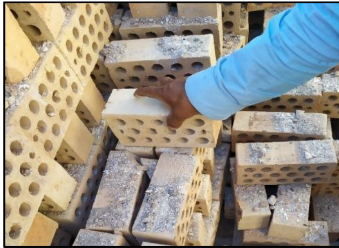
Figura 2.18. Muestreo de unidades al momento de sacar los ladrillos del horno
