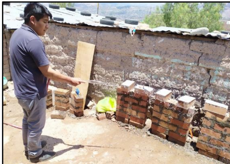
Figura 2.37. Curado de muretes de ladrillos King Kong 15 huecos
