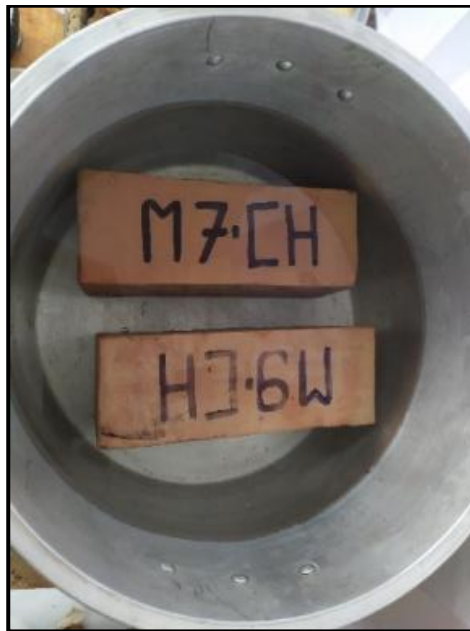
Figura 2.25. Unidades en proceso de ebullición para llegar a la absorción máxima
