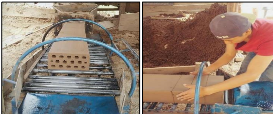
Figura 2.11. Proceso de amasado y moldeo de ladrillos King Kong 15 huecos
