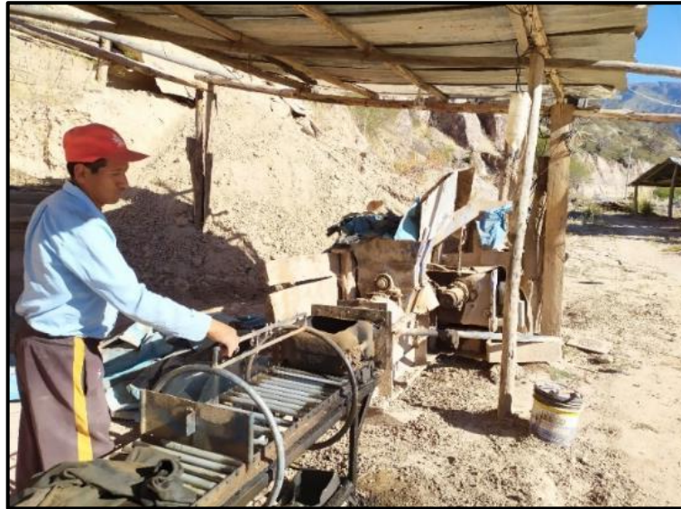
Figura 2.9. Extrusora y mesa de corte de la fábrica de ladrillos
