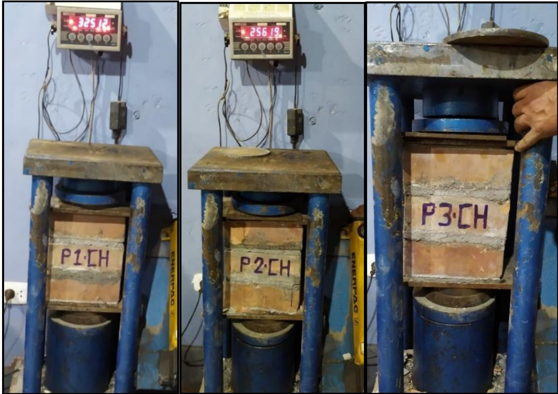
Figura 2.34. Ensayo de resistencia a la compresión en pilas de ladrillos King Kong 15 huecos
