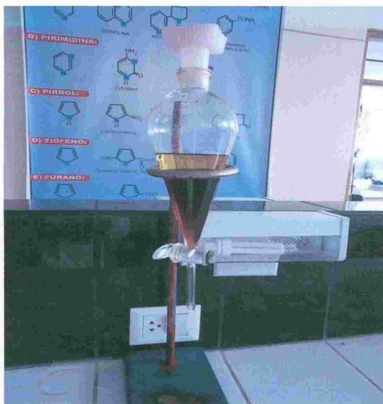
Figura 16. Equipo de extracción líquido– líquido
