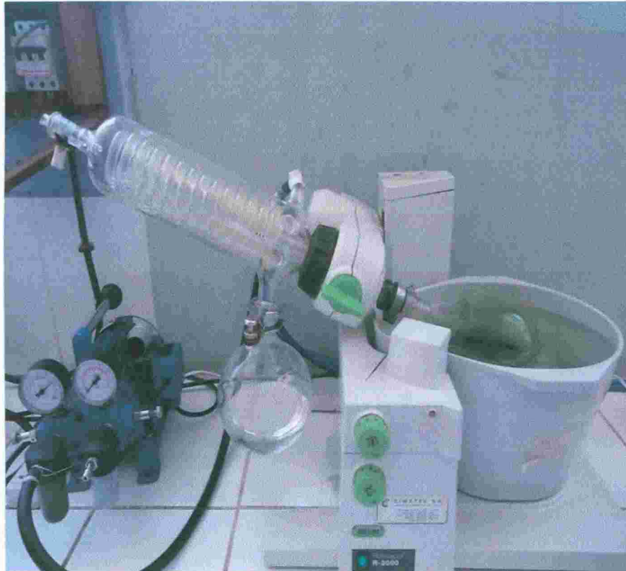
Figura 14. Equipo de rotavapor para la concentración del extracto etanólico
