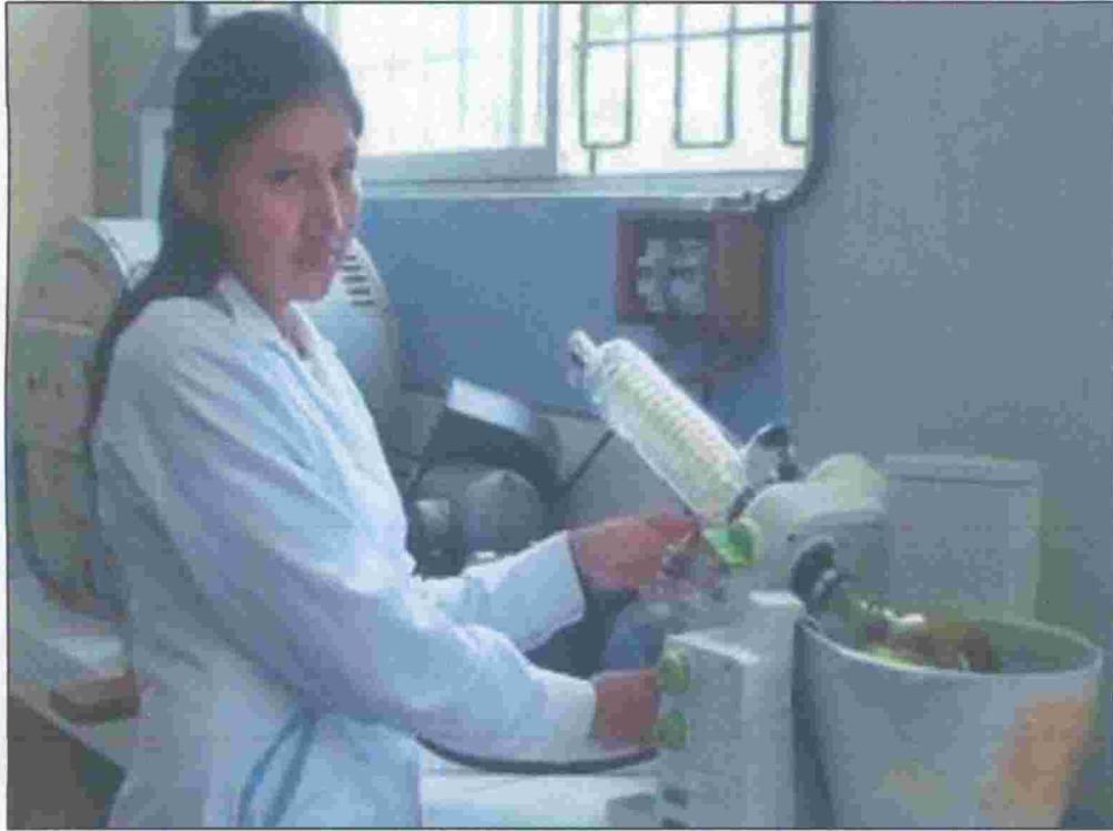
Figura 10. Obtención del extracto hidroalcohólico de las hojas de Borago officinalis L. "borraja" en el rotavapor.
