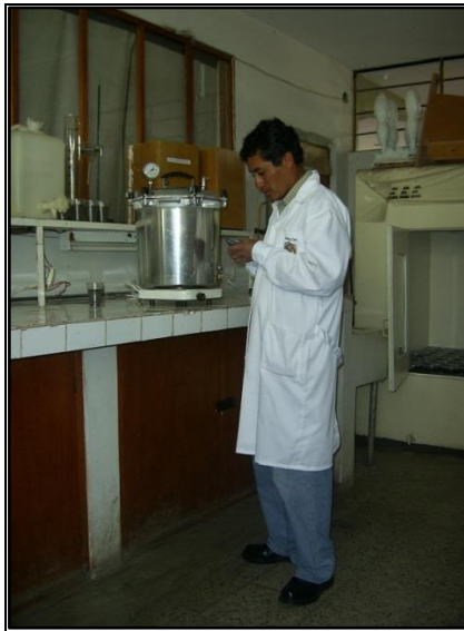
Proceso de esterilización de substrato en autoclave.
