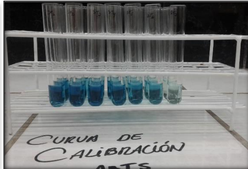
Curva de calibración del ABTS
