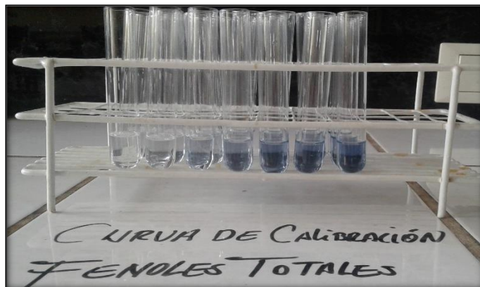
Curva de calibración para la determinación de fenoles totales
