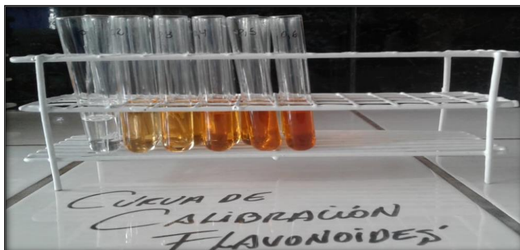
Curva de calibración para flavonoides
