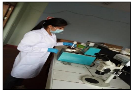
Aplicando baño maría a 37 C° por 30 minutos en la preparación de la solución de trabajo.
