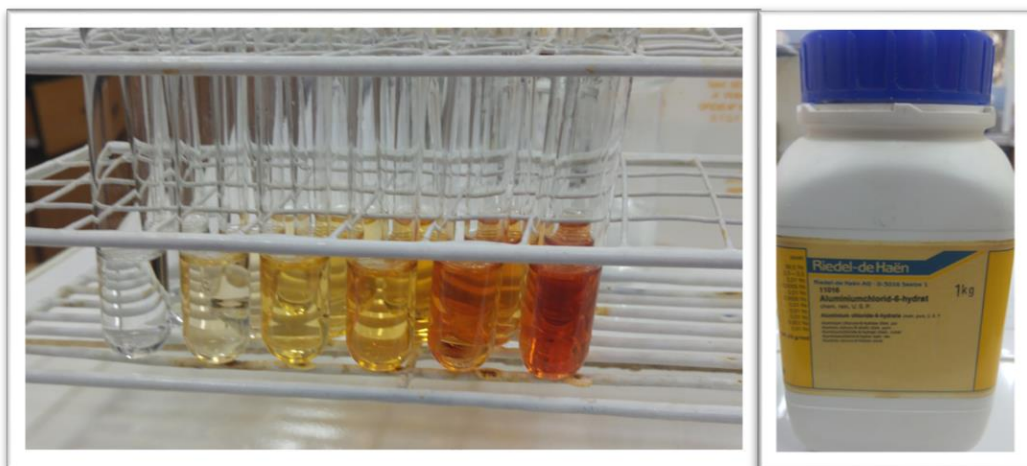
a. Reacción para curva de calibración con el método de cloruro de aluminio.
