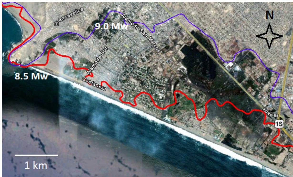
Figura 6.6: Imagen satelital para la zona de Villa - Chorrillos. La inundación máxima está en color azul para el evento sísmico de 9.0 Mw. Fuente. DHN
