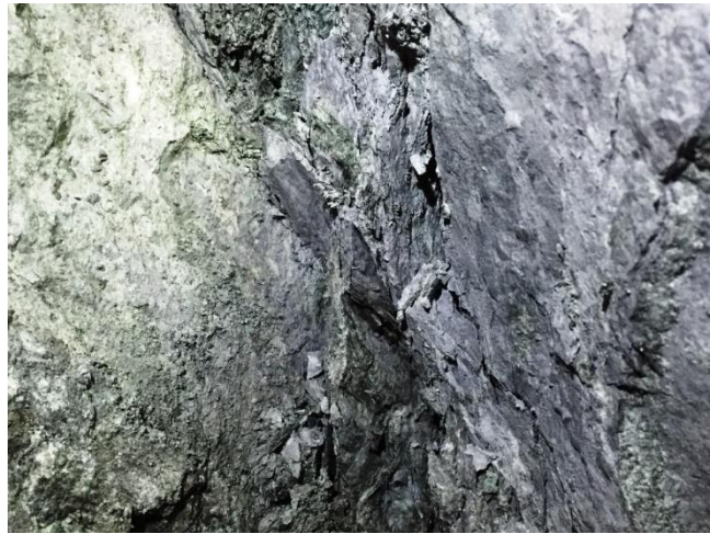
Figura 4.8. Roca intensamente fracturada y con alteración hidrotermal
