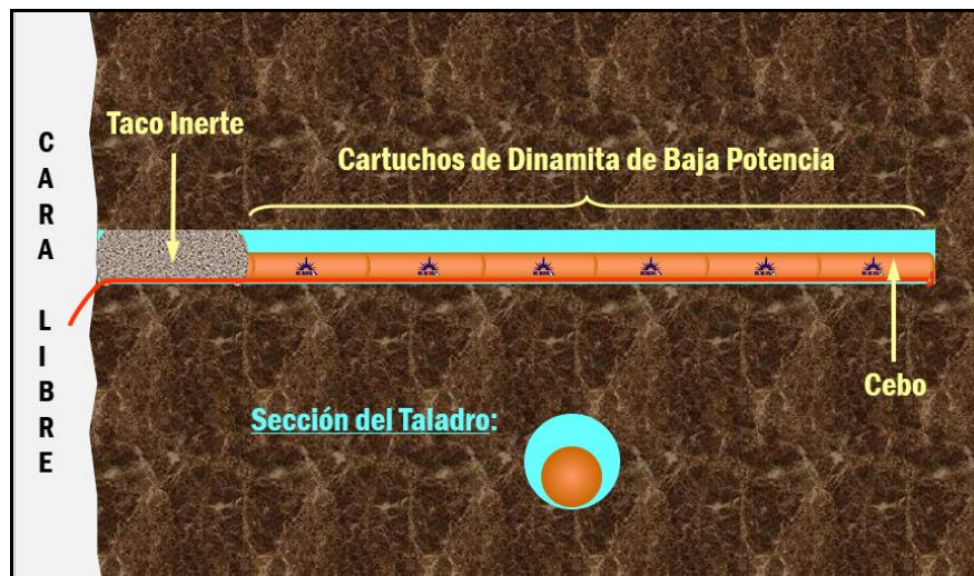
Figura 31: Esquema de Carga Explosiva Desacoplada y Continua.
