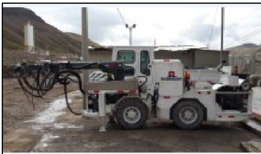
Figura 46: Equipo de Lanzado de Shotcrete Scoop de 0.70 Yd 3
