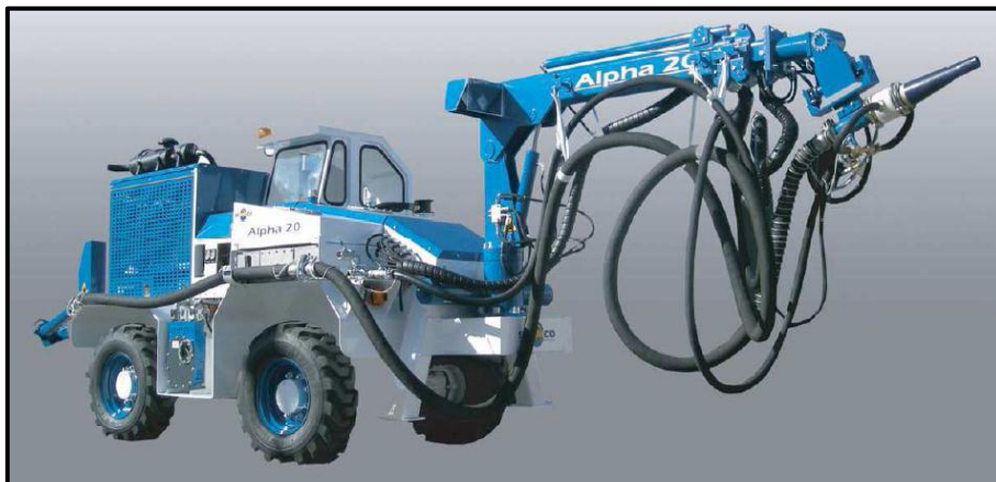
Figura 45: Equipo de Lanzado de Shotcrete Alpha 20
