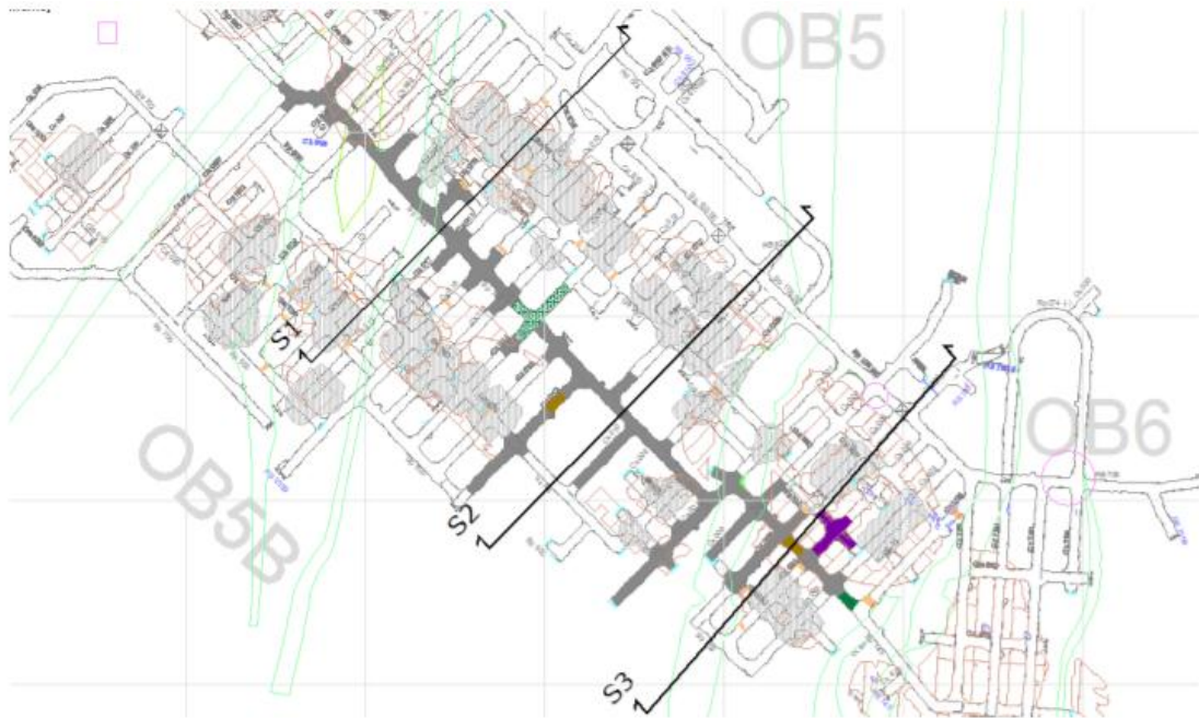
Figura 33. Plano del Nivel 1650 mostrando el bypass BP-745
