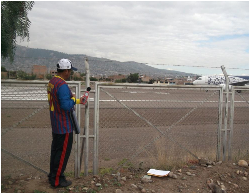
Registro de los niveles de ruido en la pista de aterrizaje del Aeropuerto Coronel FAP Alfredo Mendivil Duarte
