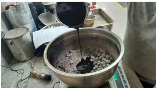
(a) Pesaje de cemento asfáltico.
