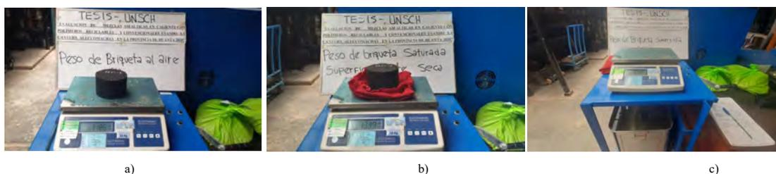
**Figura 39** a) Peso de briqueta al aire en condición seca, b) Peso de briqueta saturada superficialmente seca, c) Peso de briqueta sumergida en agua.
