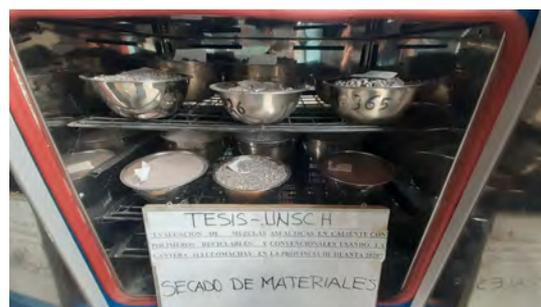
(b) Secado a horno eléctrico.
