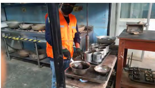
**(a)** Mezclado de mezcla asfáltica.
