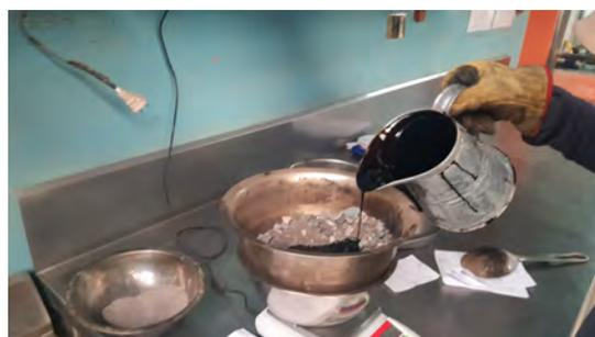
**(b)** Adición del cemento asfáltico.
