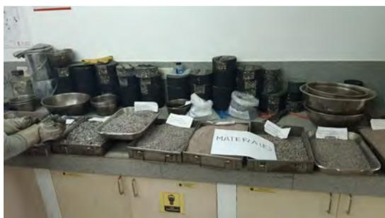
(a) Materiales para diseño de mezclas asfálticas en caliente.
