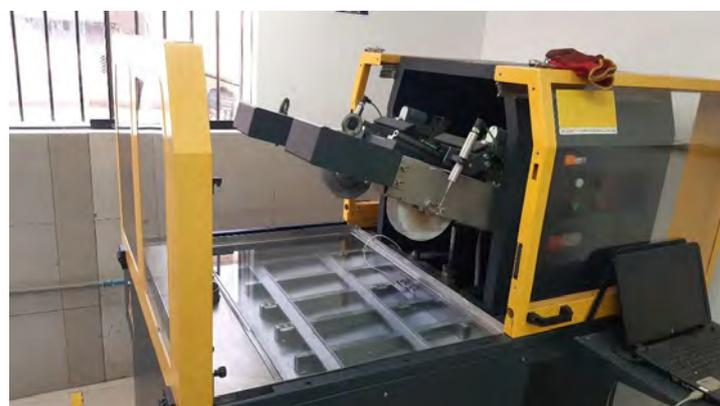
**Figura D.44** Calibración del equipo compactador giratorio y rueda de Hamburgo
