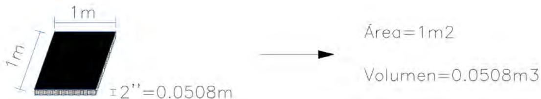
**Figura 81** Carpeta asfáltica de 1m<sup>2</sup>
