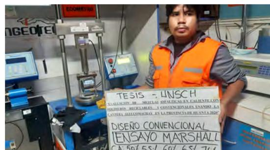
(b) Ensayo de estabilidad y fluencia.
