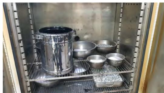
(b) Secado de materiales en horno de convección forzada.
