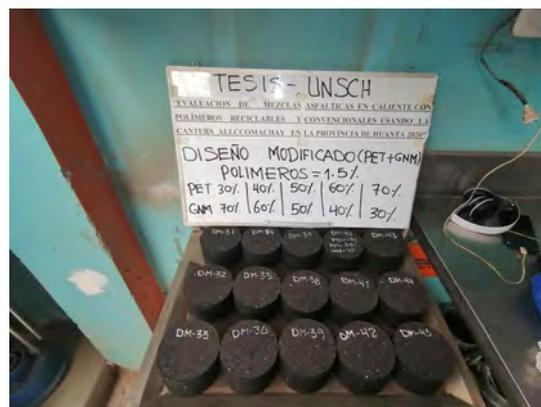
(b) Briquetas desmoldadas
