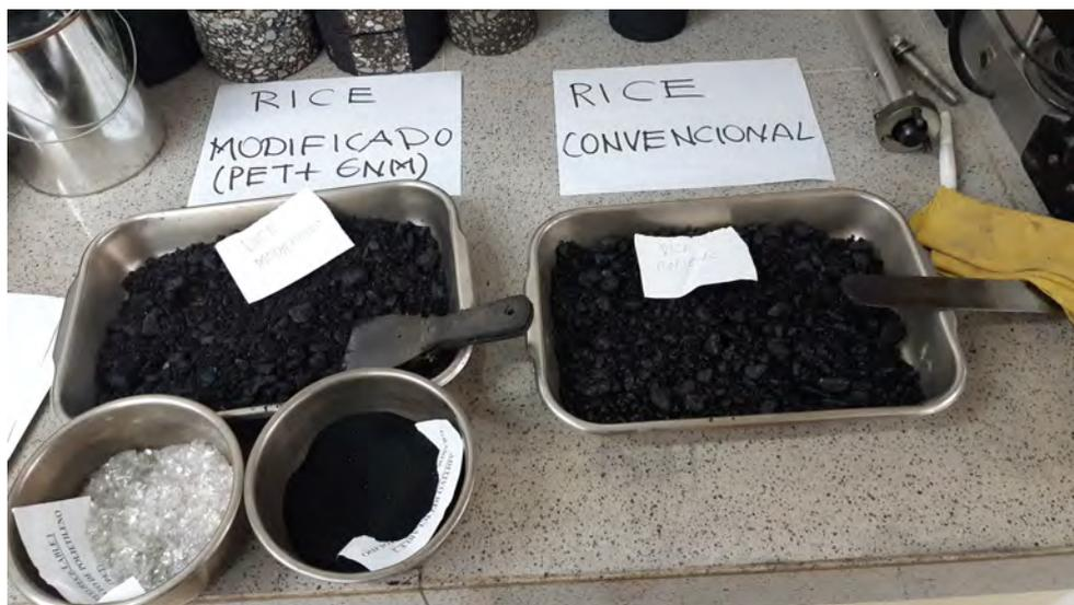
**Figura 61** Mezcla asfáltica suelta para el ensayo RICE
