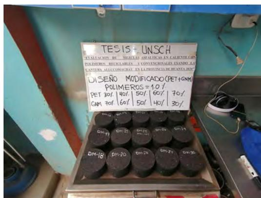
(b) Briquetas desmoldadas
