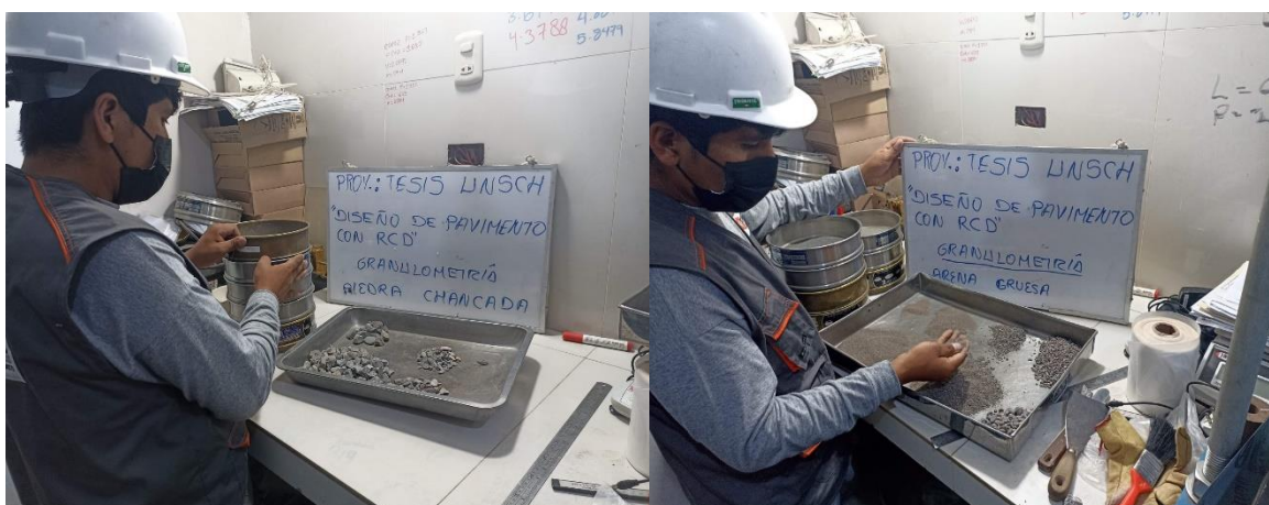
Figura 6. Análisis granulométrico por tamizado del agregado grueso y agregado fino
