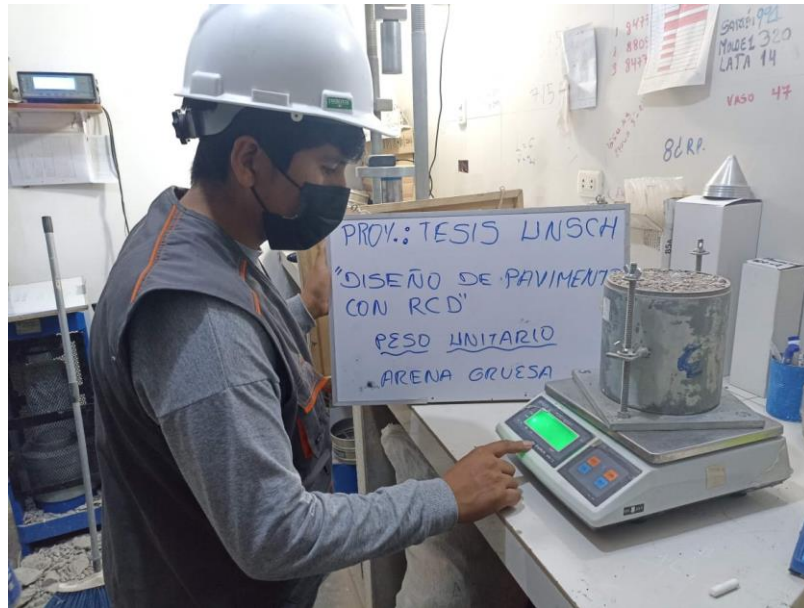
Figura 14: Peso unitario del agregado fino suelto y compactado
