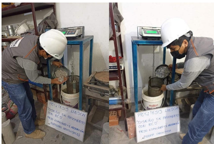
Figura 15: Determinación del peso específico y absorción del agregado grueso
