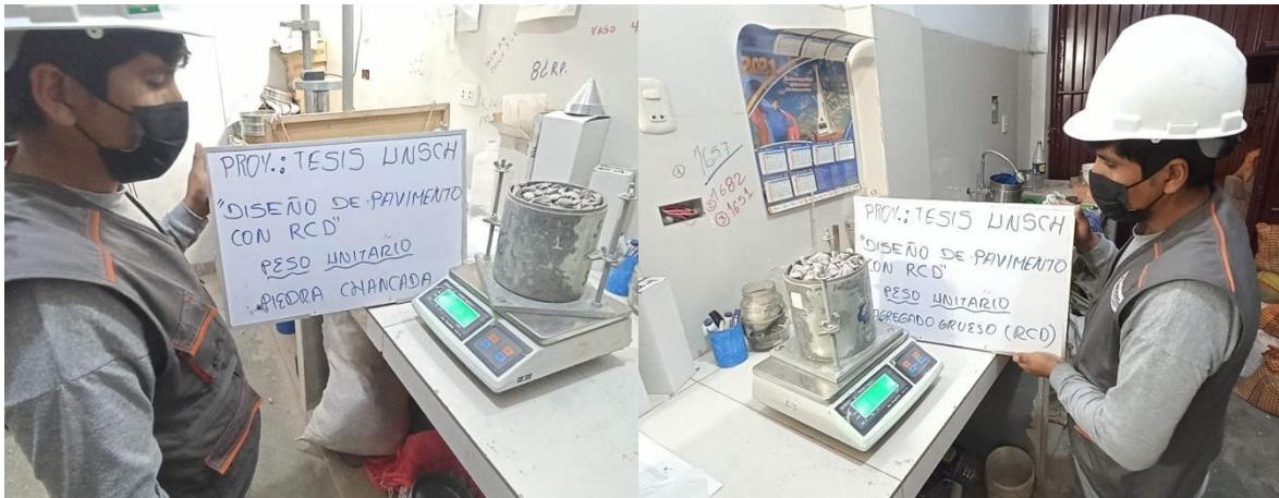
Figura 13: Peso unitario del agregado grueso suelto y compactado
