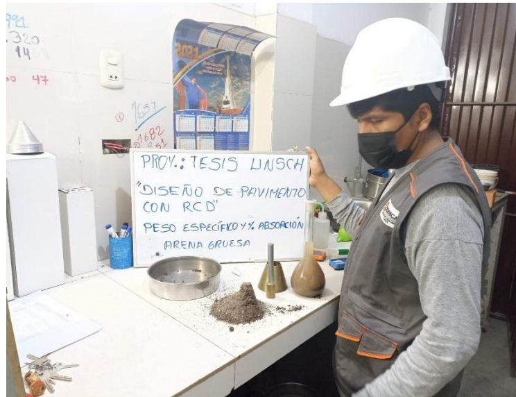
Figura 16: Determinación del peso específico y absorción del agregado fino
