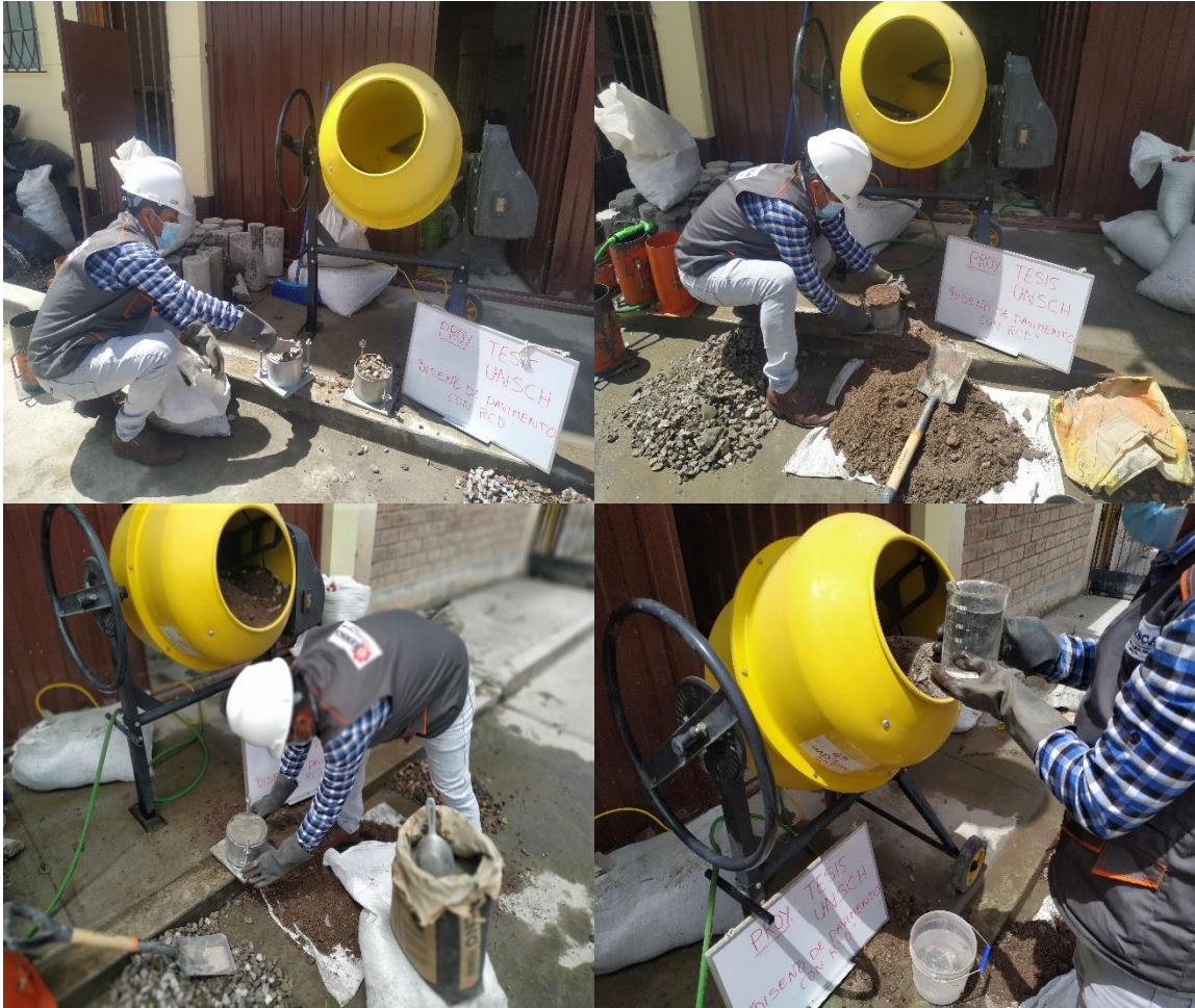
Figura 17: Diseño de mezcla de concreto para pavimento con agregado RCD
