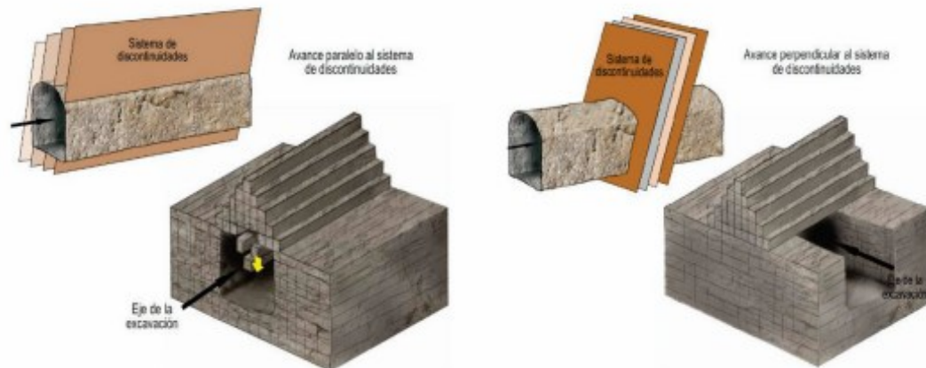
Figura 4. Orientación de la excavación con respecto a los rasgos estructurales.
